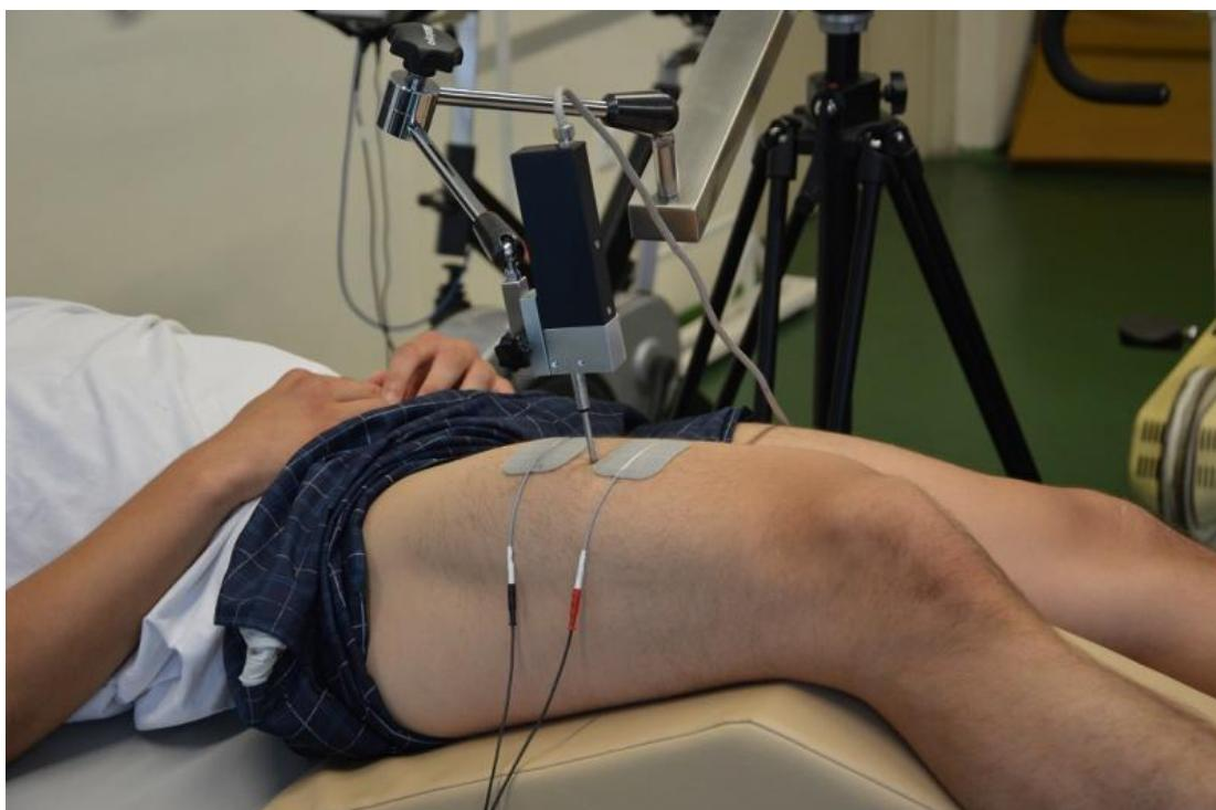
**Slika 9.** Način postavljanja elektroda i senzora
