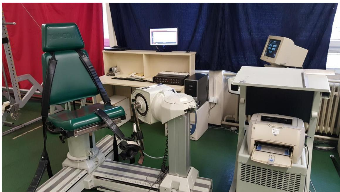
**Slika 3.** Izokinetički dinamometar
