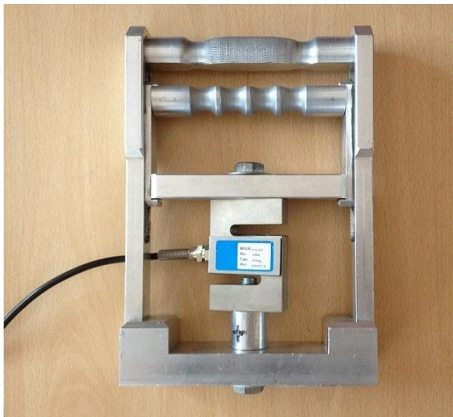
**Slika 1.** Ručni dinamometar (konstrukcija i dinamometrijska sonda)
