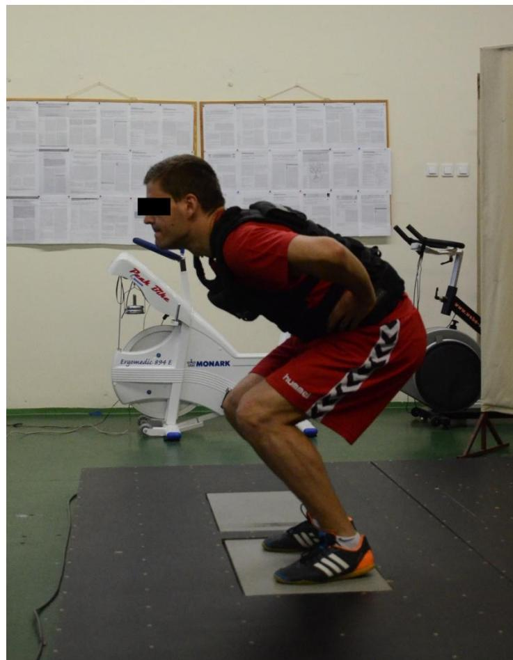
**Slika 2.** Test vertikalnog skoka na tenziometrijskim platformama
