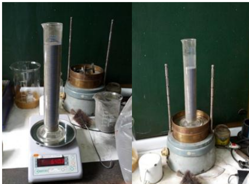
Slika 3.2 Aparatura za određivanje nasipne gustine i nasipne gustine u zbijenom stanju
