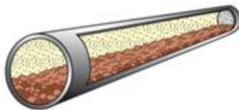
Slika 2.19 Šematski prikaz ugušćenog transporta u vidu pokretnog sloja [118]
