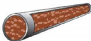
Slika 2.27 Šematski prikaz ugušćenog transporta gde materijal konstantno zauzima pun poprečni presek [118]
