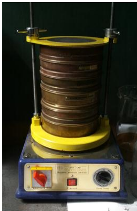
Slika 3.1 Aparatura za određivanje granulometrijskog sastava
