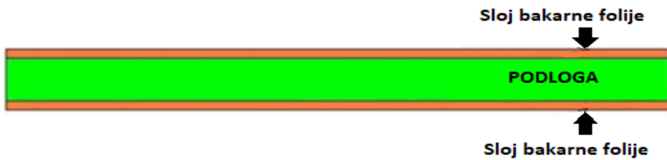
Слика 4: Попречни пресек двостране штампане плочице
