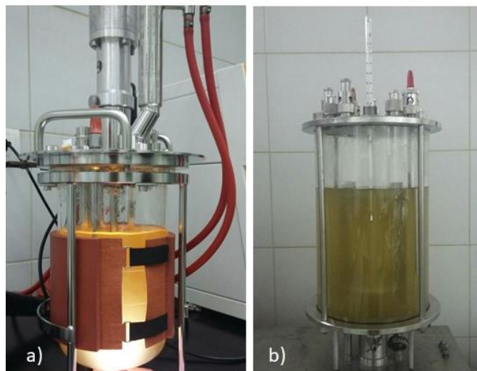
Slika 14. Korišćeni laboratorijski bioreaktori za proizvodnju biomase denitrifikatora: a) Biostat® A plus, ukupne zapremine 3 L i b) Chemap AG CH-8604, ukupne zapremine 7 L
