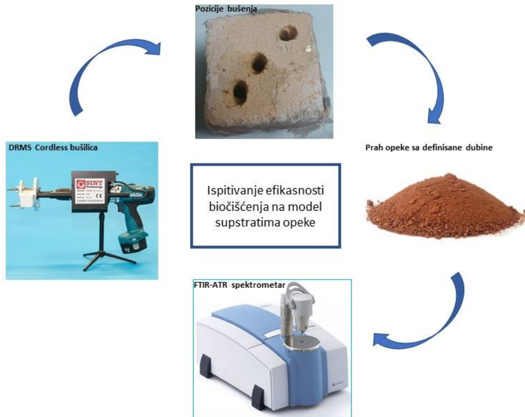
Slika 15. Šematski prikaz postupka ispitivanja efikasnosti biočišćenja na model supstratima opeke
