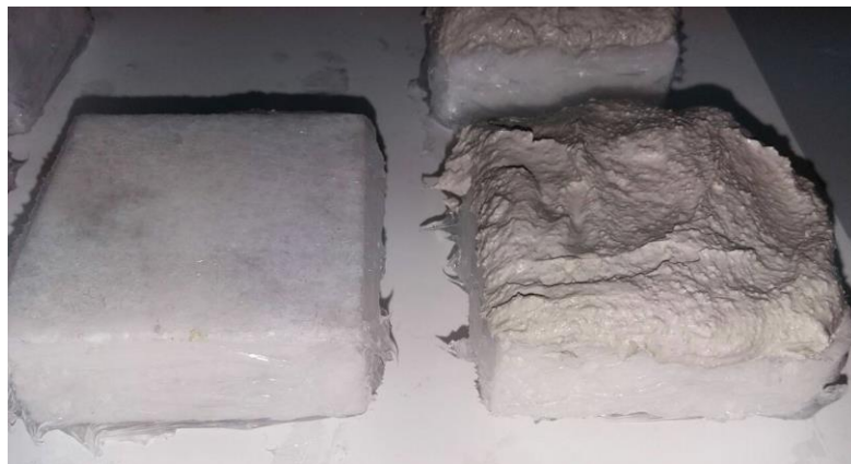
Slika 35. Stenski materijal pre (levo) i nakon (desno) postavke bioaktivnog sistema za biočišćenje
