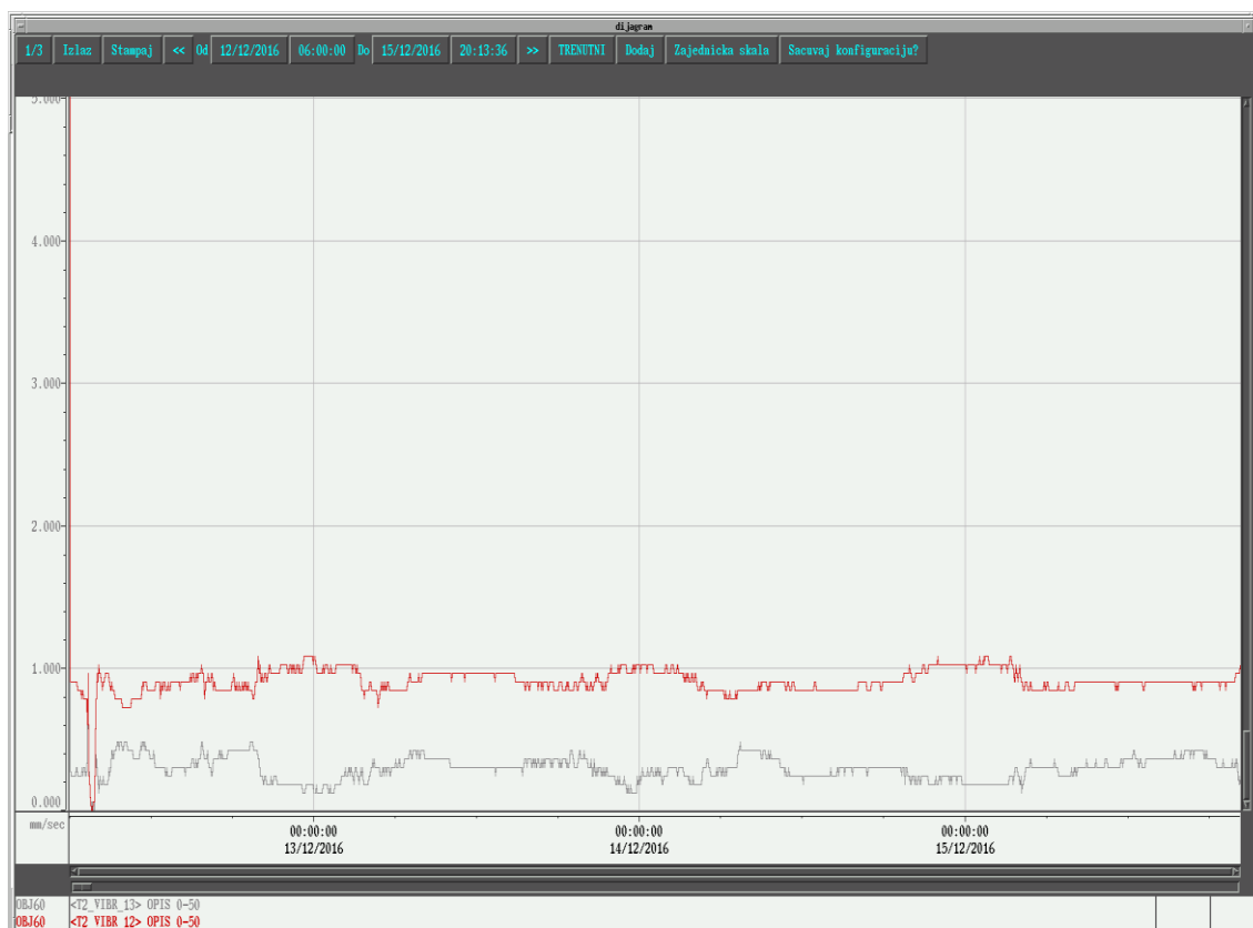
Слика 6.13: Експлоатационо праћење брзина вибрација за период од 13.12. до 15.12.2016. у току 24 часа за клизно лежиште број 6 37
