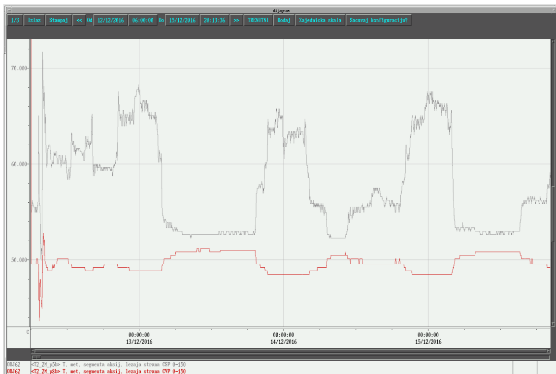
Слика 6.19: Експлоатационо праћење температура метала сегмената 2 (доњи) аксијалног лежишта са стране CSP (0-150) (сива боја) и сегмената аксијалног лежишта са стране CVP (0-150) (црвена боја) за период од 13.12. 2016. до 15.12. 2016. у току 24 часа 37
