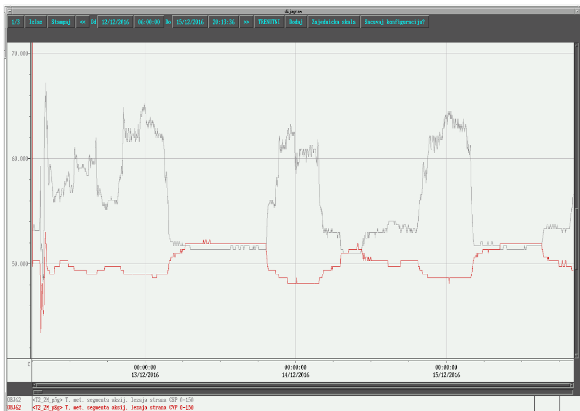
Слика 6.21: Експлоатационо праћење температура метала сегмента 4 (доњи) аксијалног лежишта са стране CSP (0-150) и сегмента аксијалног лежишта са стране CVP (0-150) за период од 13.12. 2016. до 15.12. 2016. у току 24 часа 37
