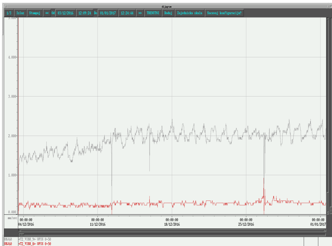
Слика 6.3: Експлоатационо праћење брзина вибрација за период од 4.12.2016 до 1.1. 2017. у току 24 часа за клизно лежиште број 3 37
