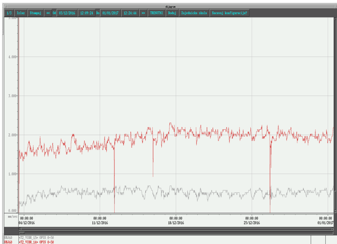
Слика 6.7: Експлоатационо праћење брзина вибрација за период од 4.12.2016 до 1.1. 2017. у току 24 часа за клизно лежиште број 7 37
