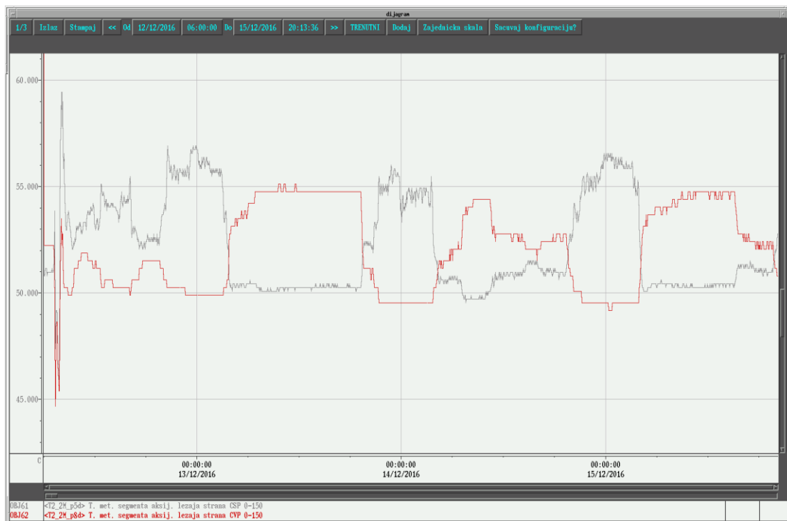
Слика 6.22: Експлоатационо праћење температура метала сегмента 5 (доњи) аксијалног лежишта са стране CSP (0-150) и сегмента аксијалног лежишта са стране CVP (0-150) за период од 13.12. 2016. до 15.12. 2016. у току 24 часа 37
