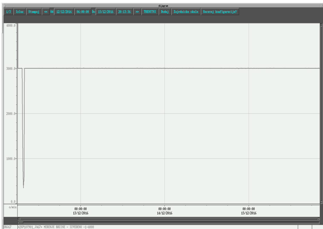
Слика 6.16: Експлоатационо праћење броја обртаја ротора за период од 13.12. до 15.12. 2016. у току 24 часа 37
