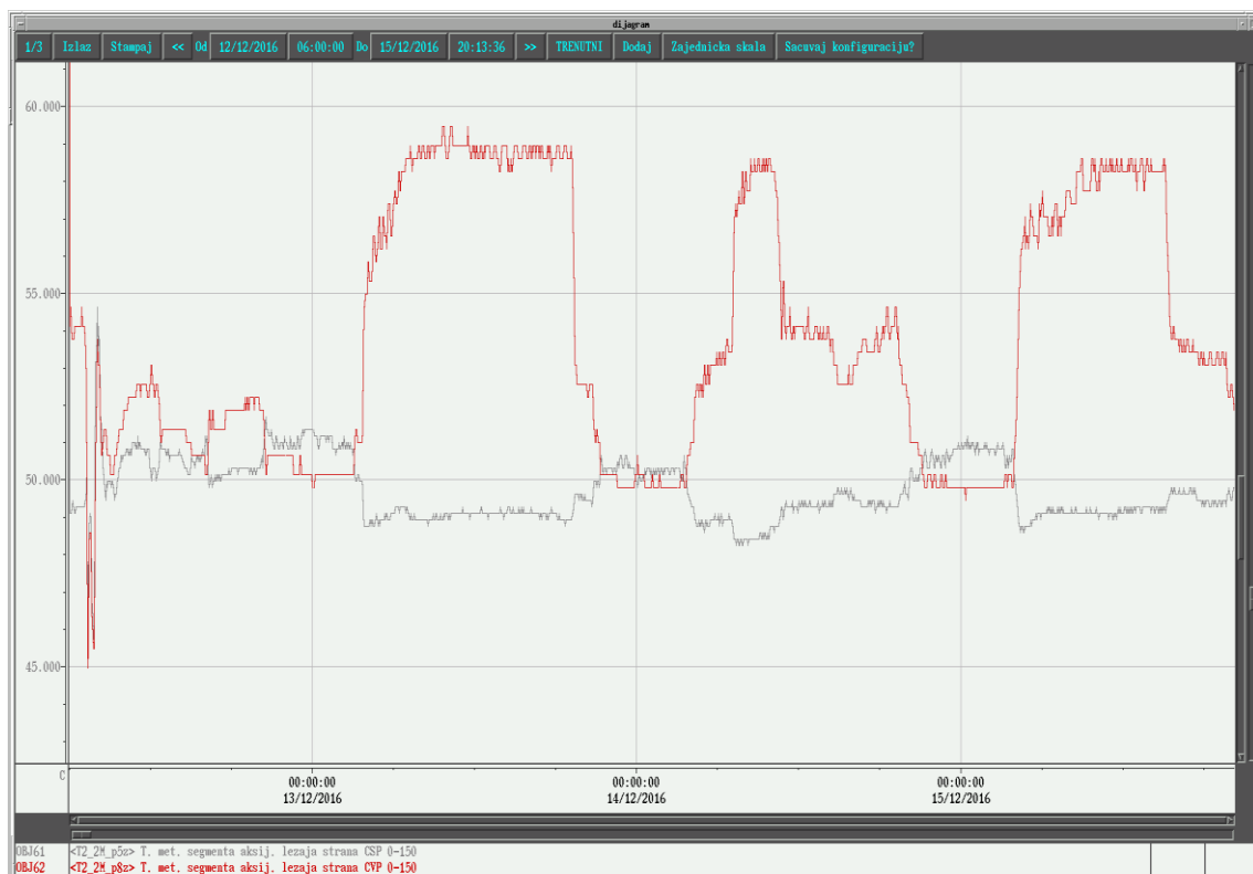
Слика 6.24: Експлоатационо праћење температура метала сегмената 7 (горњи) аксијалног лежишта са стране CSP (0-150) и сегмената аксијалног лежишта са стране CVP (0-150) за период од 13.12. 2016. до 15.12. 2016. у току 24 часа 37
