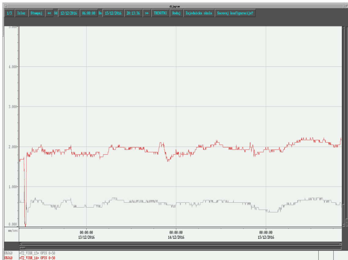
Слика 6.14: Експлоатационо праћење брзина вибрација за период од 13.12. до 15.12.2016. у току 24 часа за клизно лежиште број 7 37
