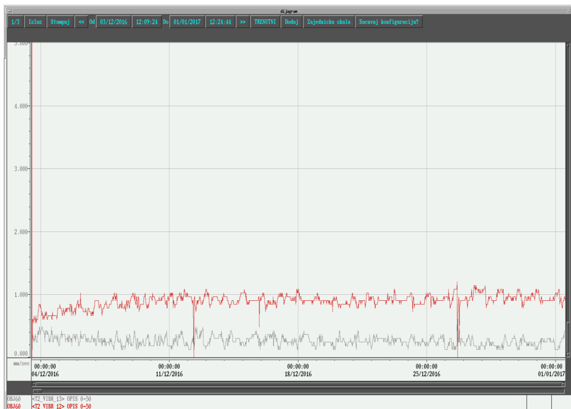
Слика 6.6: Експлоатационо праћење брзина вибрација за период од 4.12.2016 до 1.1. 2017. у току 24 часа за клизно лежиште број 6 37
