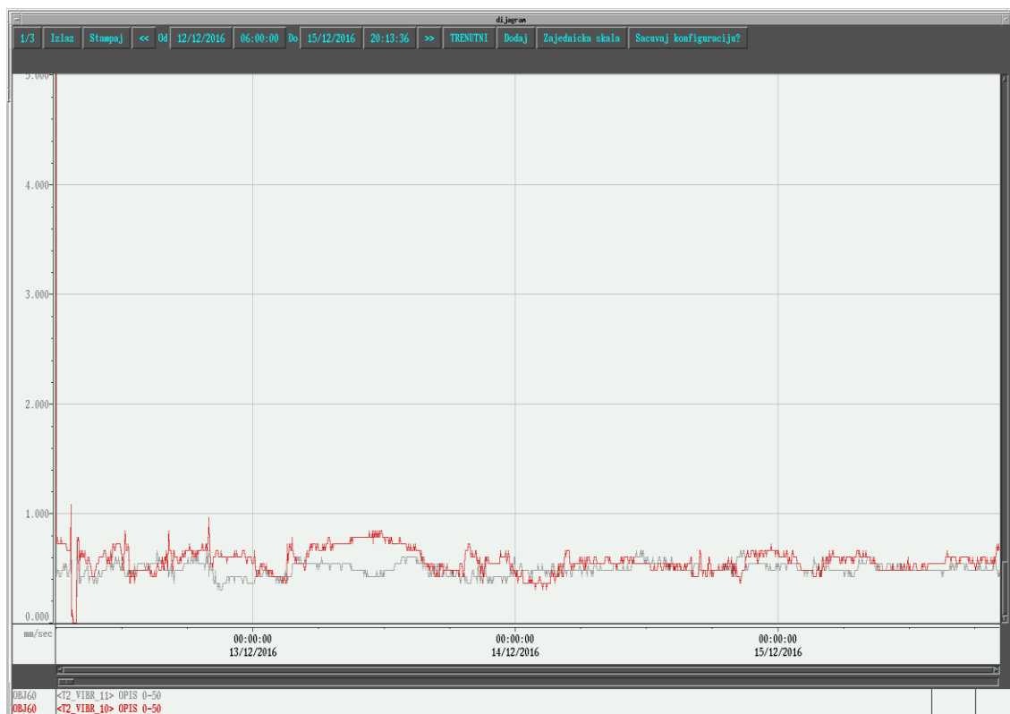
Слика 6.12: Експлоатационо праћење брзина вибрација за период од 13.12. до 15.12.2016. у току 24 часа за клизно лежиште број 5 37
