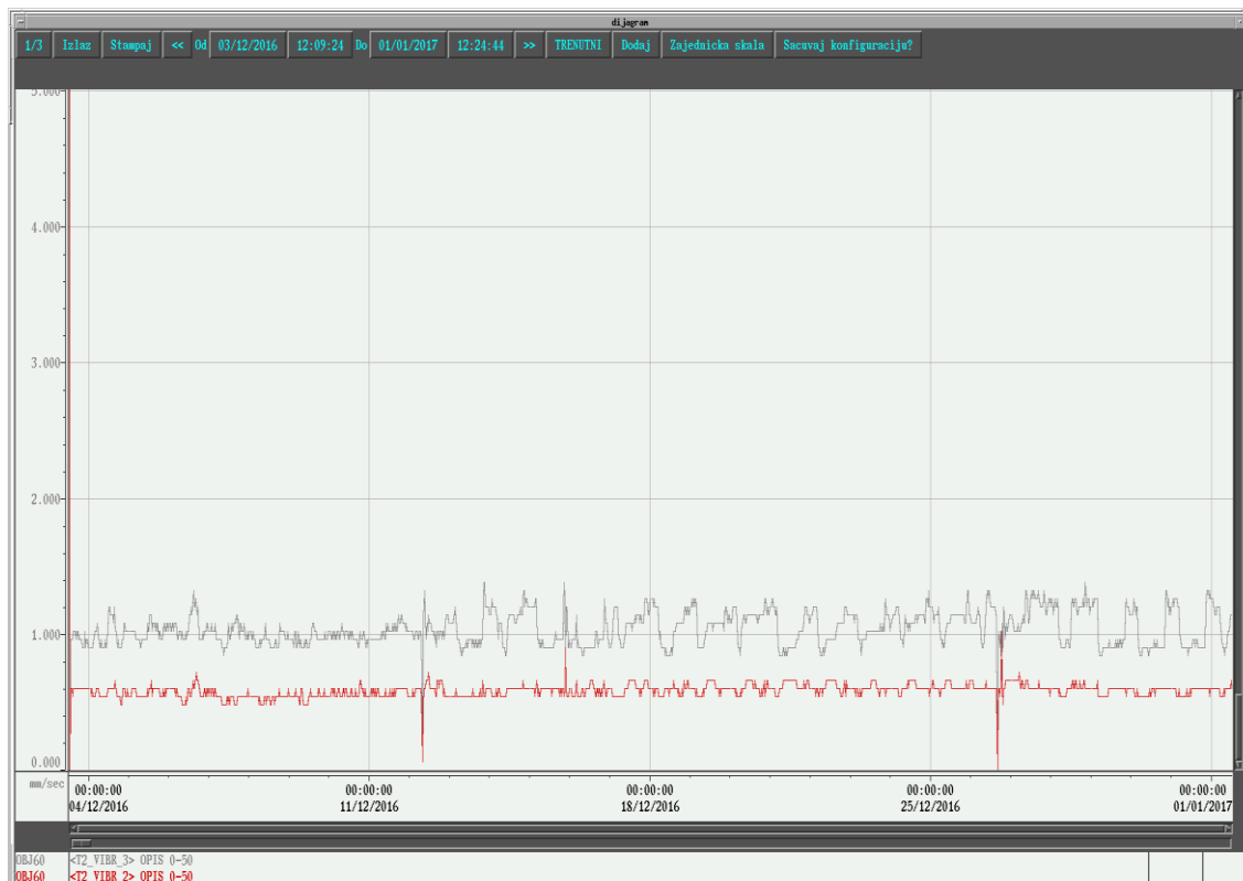
Слика 6.1: Експлоатационо праћење брзина вибрација за период од 4.12.2016 до 1.1. 2017. у току 24 часа за клизно лежиште број 1 37
