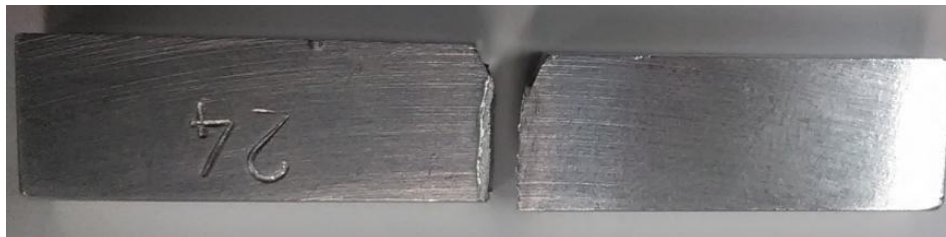
Slika 3.45 Polomljena Charpy epruveta iz osnovnog materijala EN AW 7949A u stanju T652
