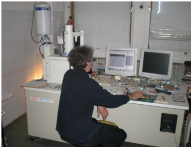
Slika 3.73 Operater u trenutku SEM/EDS analize jednog od uzoraka nastalog poslije loma legure EN AW 7049 A na skening elektronskom mikroskopu tip JEOL JSM -6460LV
