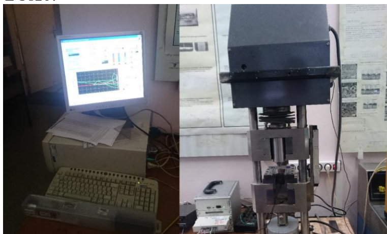
Slika 3.57 Kidalica tipa SMITWELD 1405 korišćena za ispitivanja zamorom SENB epruvete opremljena računarskom jedinicom za akviziciju i kontrolu podataka
