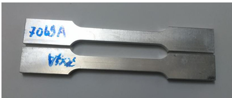
Slika 3.35 Fotografije epruveta za statička ispitivanja osnovnog materijala
