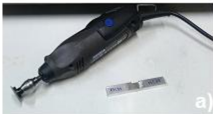
Slika 3.51 a) Brusilica za fino brušenje pored SENB epruvete b) izgled okoline prsline na epruveti sa vidljivim bočnim zljebovima
