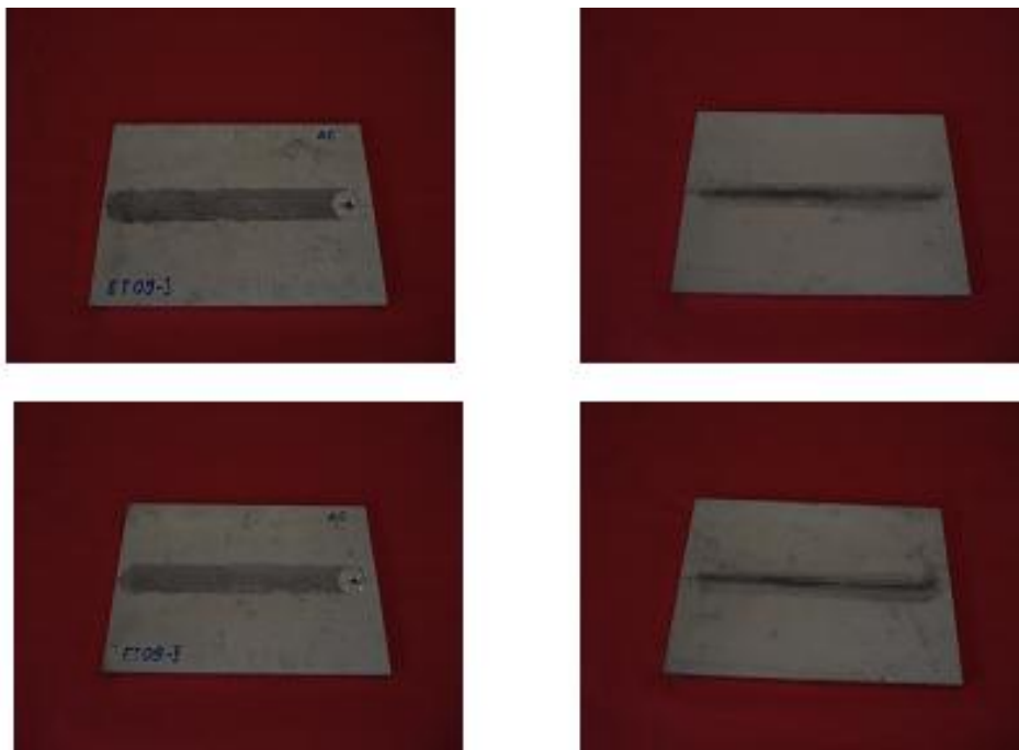
Slika 4.31 Izgled lica i korjena MŠ za ET 09 zavarenu sa alatom tip C
