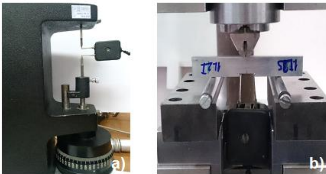
Slika 3.60 a) Uređaj za kalibrisanje ekstenziometra, b) Ekstenziometar na mjernom mjestu na vrhovima "lastinog repa" epruvete
