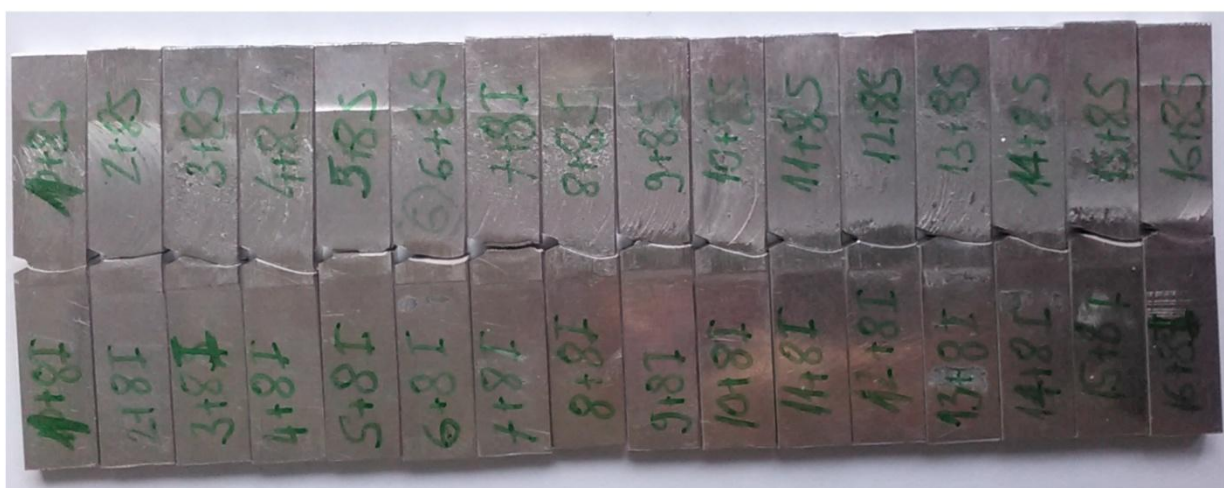
Slika 3.47 Izgled polomljenih epruveta u svim tačkama eksperimenta nakon Charpy testa sa zarezom udaljenim 8 mm od centra na povratnoj strani MŠ
