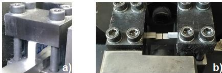
Slika 3.56 Centriranje i montaža SENB epruvete po a) širini b) dužini u prihvatno-steznoj glavi za zamaranje uređaja tip Cractronic Rumul
