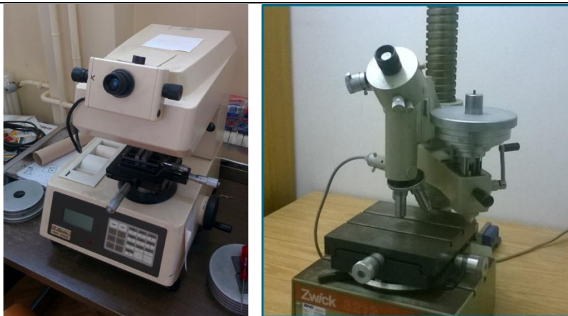
Slika 3.32 Izgled uređaja za mjerenje tvrdoće tip Shimadzu HVM 2000 i tip ZWICK 3202
