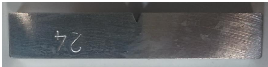
Slika 3.44 Izgled epruvete za Sharpy ispitivanja iz osnovnog materijala EN AW 7049A T 652
