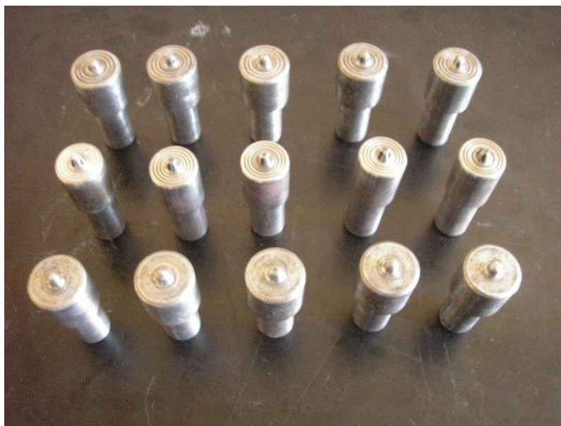
Slika 3.11 Setovi alata za ZTM različite geometrije i izgleda čela i trna alata
