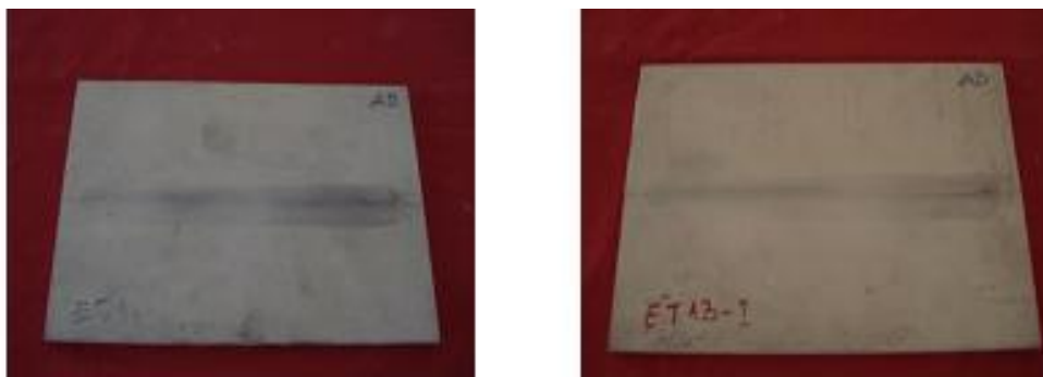
Slika 4.36 Izgled korjena MŠ nakon testa penetrantima uzorka ET 13 zavarenog alatom tip D
