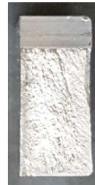
Slika 4.64 Grafički prikaz odnosa sila-vrijeme i energija-vrijeme sa izgledom prelomne površine na zarezu udaljenom 4mm (IS) od centra MŠ za ET 01(alat A, v=80 mm/min, n= 850 min -1 )
