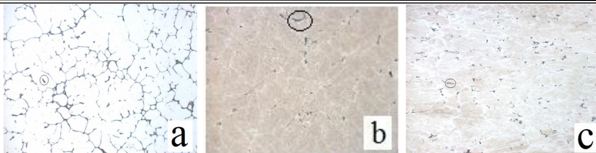
Slika 3.2 Mikrostruktura osnovnog materijala uzorka a) liveno stanje (uvećanje x200 ) b) stanje nakon homogenizacije (uvećanje x 200 ) c) termički obrađeno stanje otkovka(uvećanje x200) [251]
