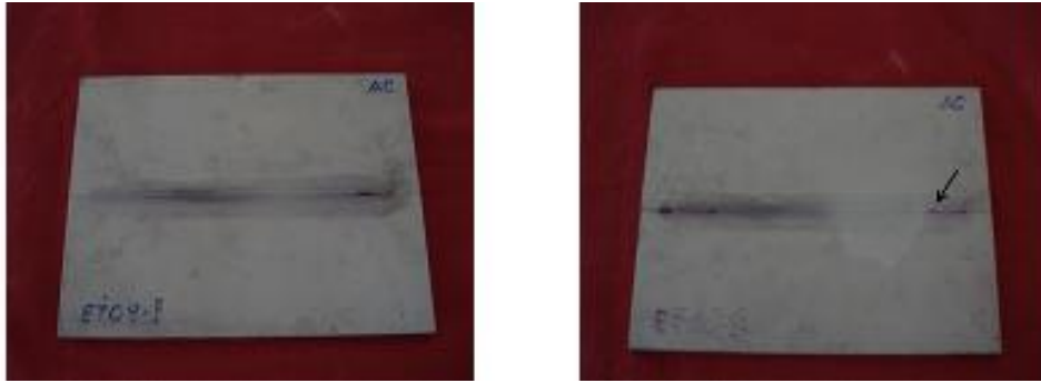
Slika 4.35 Izgled korjena MŠ nakon testa penetrantima uzorka ET 09 zavarenog alatom tip C
