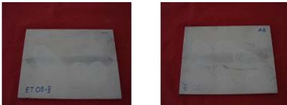
Slika 4.34 Izgled korjena MŠ nakon testa penetrantima uzorka ET 05 zavarenog alatom tip B
