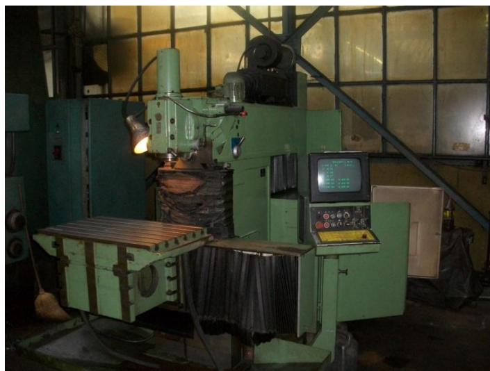
Slika 3.6 Izgled alatne glodalice tip AG 400 sa CNC upravljačkom jedinicom NCT 99 za ZTM u eksperimentu
