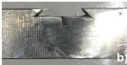
Slika 3.51 a) Brusilica za fino brušenje pored SENB epruvete b) izgled okoline prsline na epruveti sa vidljivim bočnim zljebovima
