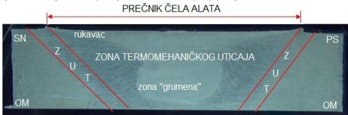
Slika 2.24 Makrostrukturni prikaz strukturnih sadržaja zavarenog spoja u jednoj od eksperimentalnih tačaka urađenih za vrijeme probnih zavarivanja legure EN AW 7049A T 652
