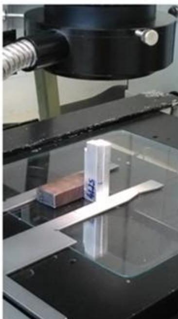
Slika 3.64 Ispitivanje dužine prsline u zoni "grunena" MŠ polomljene SENB epruvete pod mikroskopom u jednoj od eksperimentalnih tačaka
