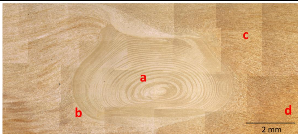
Slika 3.30 Prikaz makrostrukture mape MŠ u jednoj od eksperimentalnih tačaka sa identifikacijom mjesta za ispitivanje mikrostrukture ( a –zona “grumena”, b-ZTMU, c-ZUT i d-OM)
