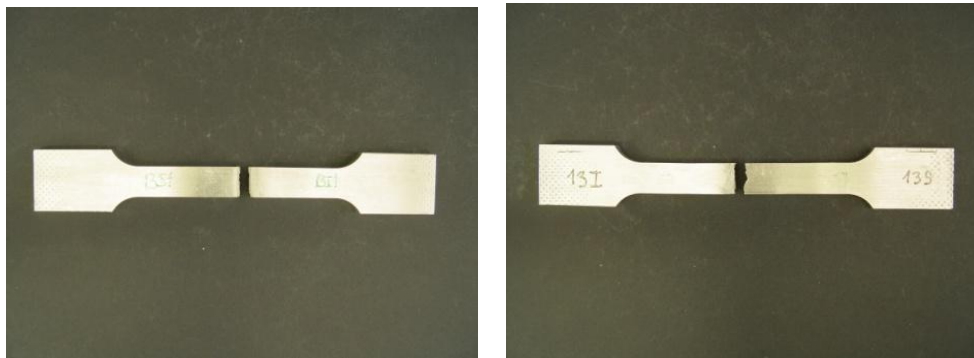
Slika 4.56 Inženjerski dijagram zatezanaja i izgled epruveta poslije prekida u ET 13 zavarenoj sa alatom tip D
