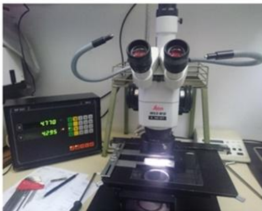
Slika 3.54 Mikroskop tip Leica WILD M10 u trenutku mjerenja zarezna na jednoj od epruveta
