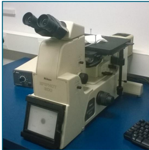
Slika 3.29 Izgled mikroskopa Nikon tip Epiphot 300 sa pratećom opremom za metalografska ispitivanja zavarenih spojeva
