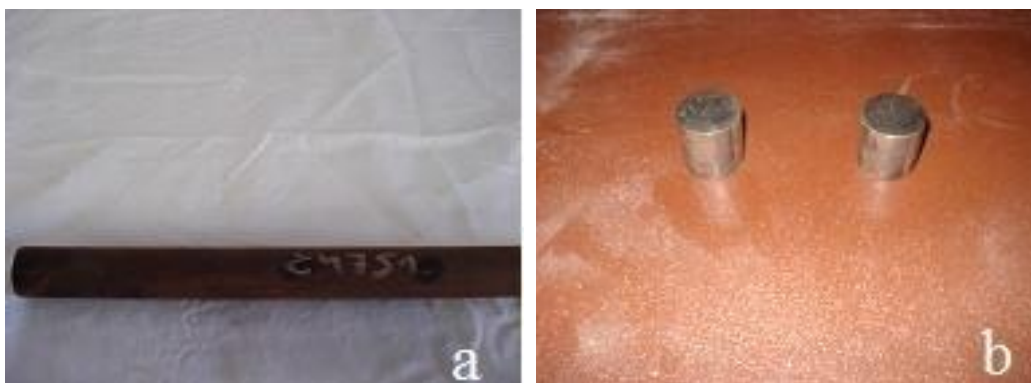
Slika 3.12 Izled a) pripremak za izradu alata b) uzorci za spektroskopsku analizu hemijskog sastava
