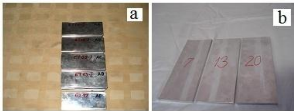
Slika 3.5 Uzorci za glavna ZTM a) pet uzoraka namijenjenih zavarivanju različitim tipovima alata nakon sječenja vodenim mlazom b) tri uzorka nakon glodanja i odmašćivanja
