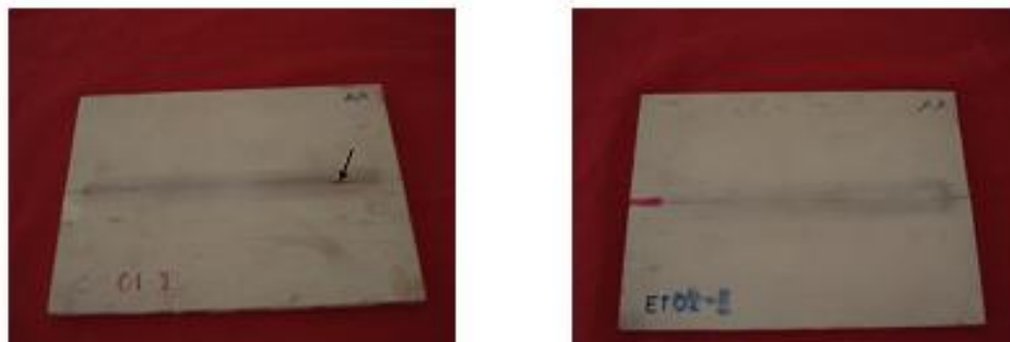
Slika 4.33 Izgled korjena MŠ nakon testa penetrantima uzorka ET 01 zavarenog alatom tip A
