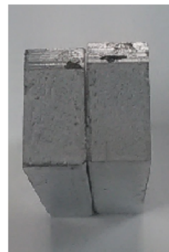
Slika 4.59 Grafički prikaz odnosa sila – vrijeme i energija – vrijeme sa izgledom epruvete iz osnovnog materijala poslije loma
