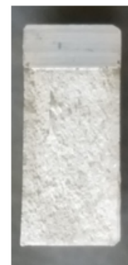
Slika 4.71 Grafički prikaz odnosa sila-vrijeme i energija -vrijeme sa izgledom prelomne površine na zarezu udaljenom 8mm (IS) od centra MŠ za ET 16(alat D, v=60 mm/min, n= 850 min -1 )
