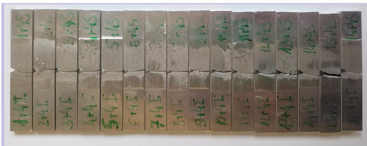
Slika 3.46 Izgled polomljenih epruveta u svim tačkama eksperimenta nakon Charpy testa sa zarezom udaljenim 4 mm od centra na povratnoj strani MŠ
