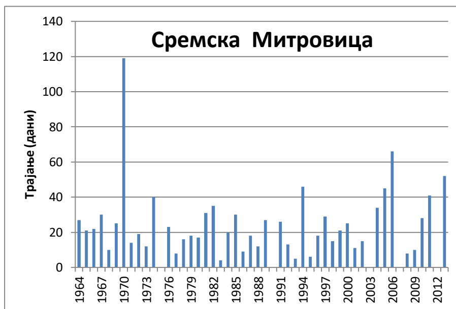
Прилог I 28: Трајање великих вода Саве код станице Сремска Митровица за период 1964-2013.
