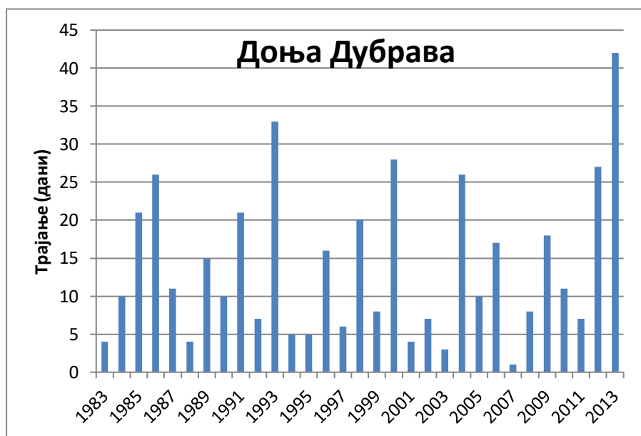
Прилог I 38: Трајање великих вода Драве код станице Доња Дубрава за период 1964-2013.
