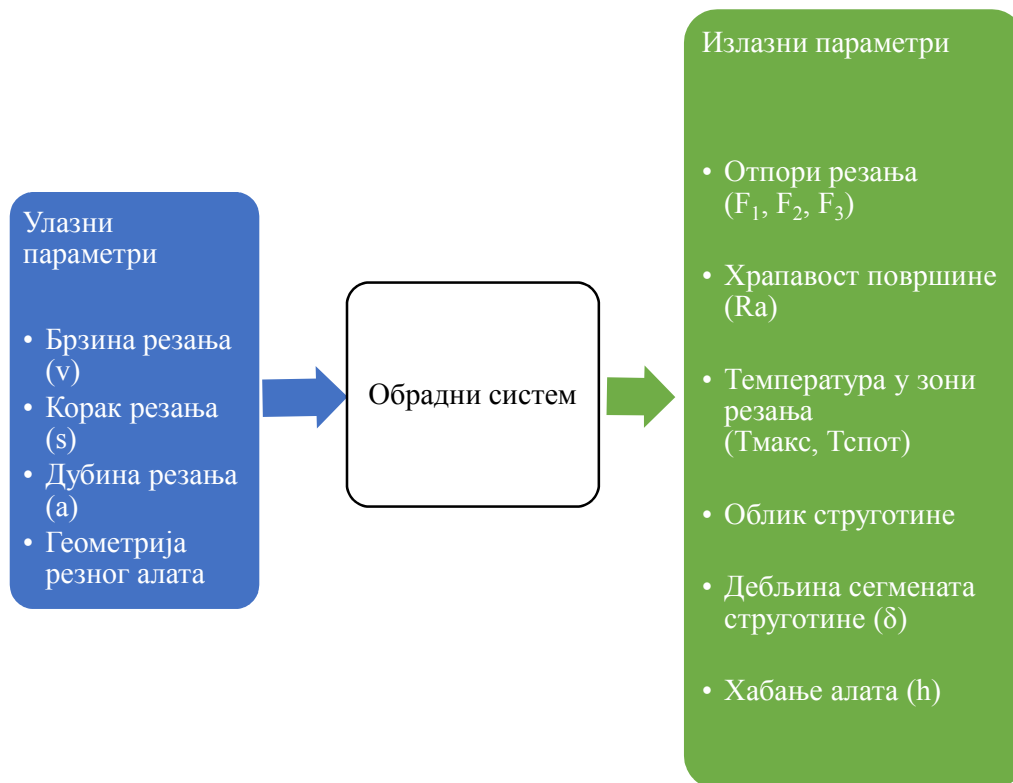
Слика 4.1. Структура обрадног система при експерименталним испитивањима
