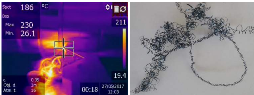
Слика 5.22. Распоред температуре у зони резања: Дуга замршена струготина (ознака 2.3 према ISO 3685) ( s : 0.1-0.25 mm/o, v : 78-156 m/mm, a : 0.3-1.5 mm)
