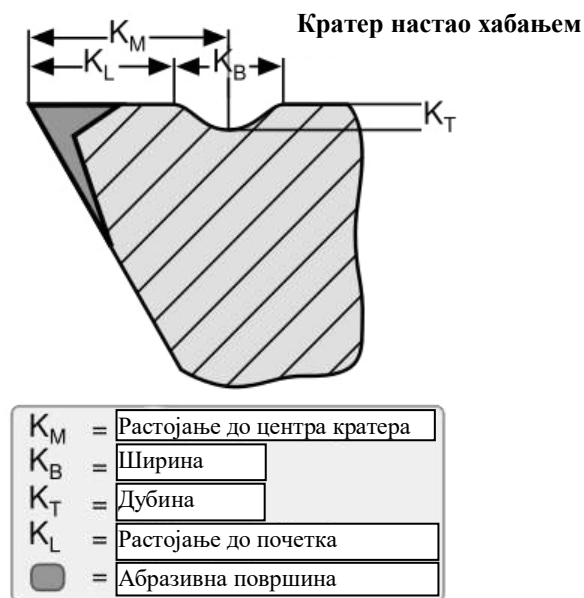
Слика 2.27. Кратер на стругарском ножу настао као последица хабања [82, 83, 115]
