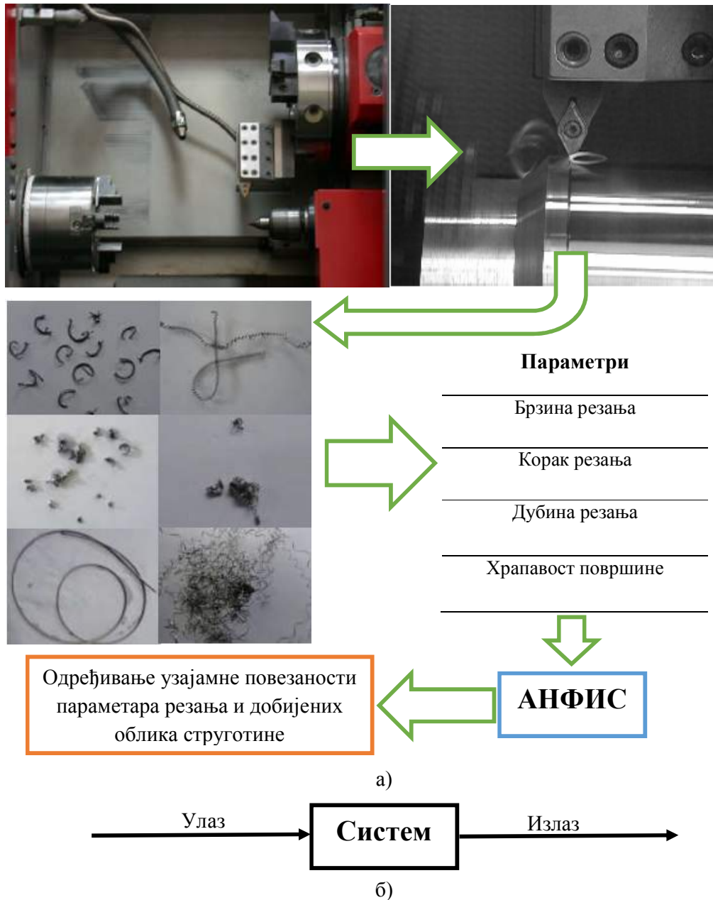
Слика 6.3. а) Шема експерименталне процедуре за АНФИС модел-1, б) општи облик шеме
