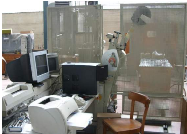
Слика 3.6. Изглед инструментираниог и компјутеризованог Шарпи клатна
