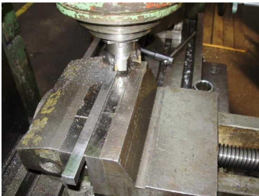
Слика 2.12. Обрада глодањем епрувете за испитивање ударне жилавости
