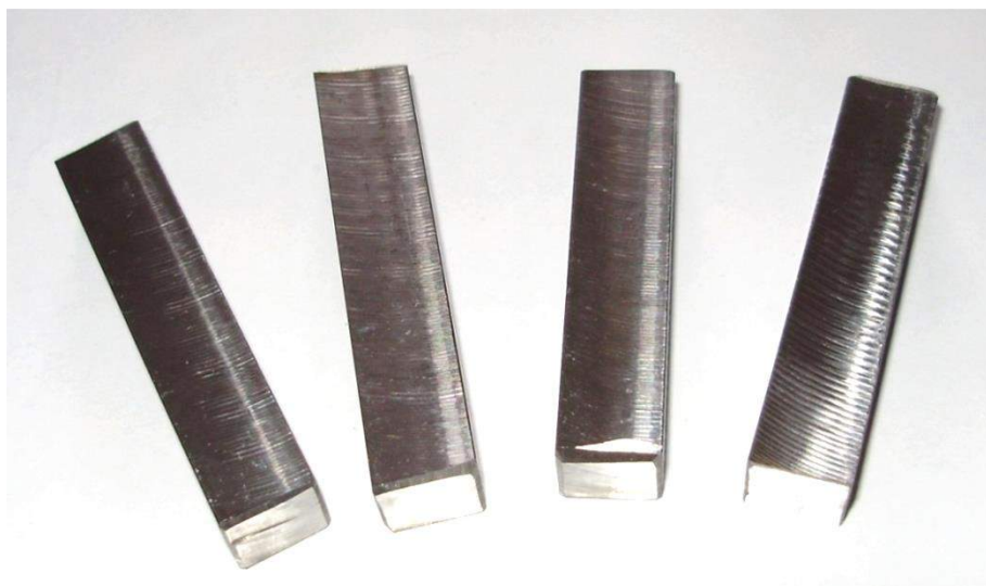
Слика 2.13. Епрувете за испитивање ударне жилавости после фазе глодања
