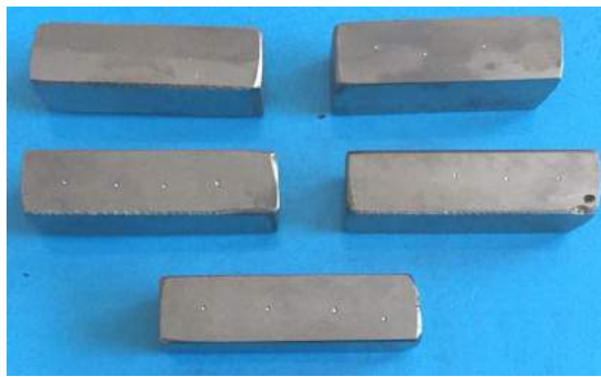
Слика3.3. Изглед отиска мерења тврдоће
