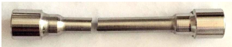
Слика 3.16. Епрувета после лома
