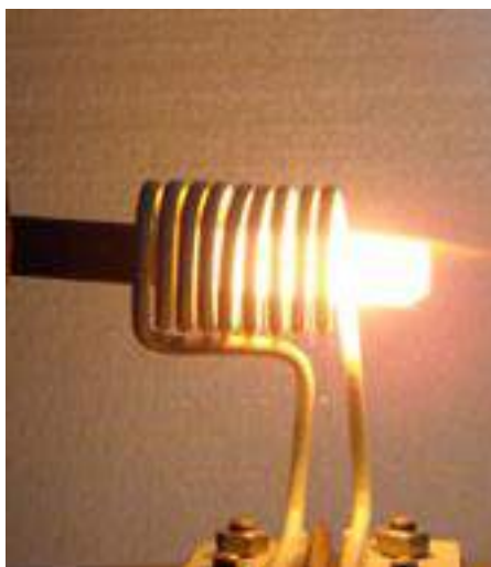
Слика 2.7. Загревање узорака у пећи Eling IP-100
