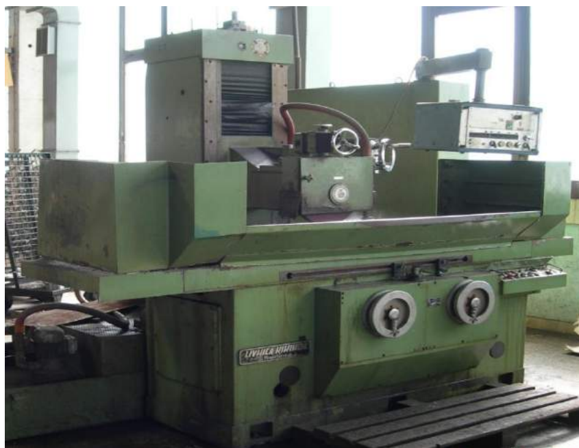
Слика 2.14. Брусилница LŽTK Кикинда тип: PRB 500/800
