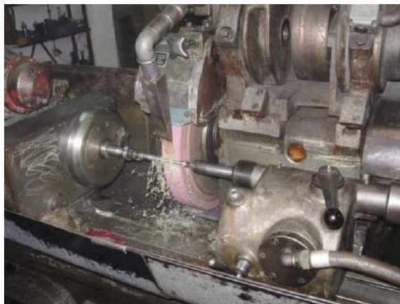
Слика 2.9. Брушење епрувета
