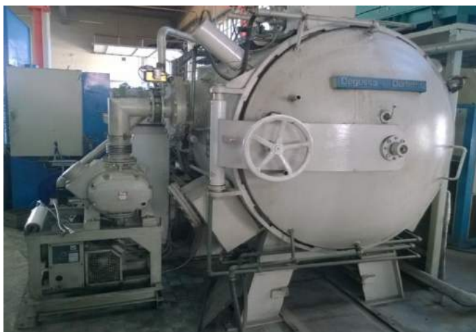
Слика 2.8. Коморна пећ Degussa – Durferrit, тип: VKUQ-60/60/98,
