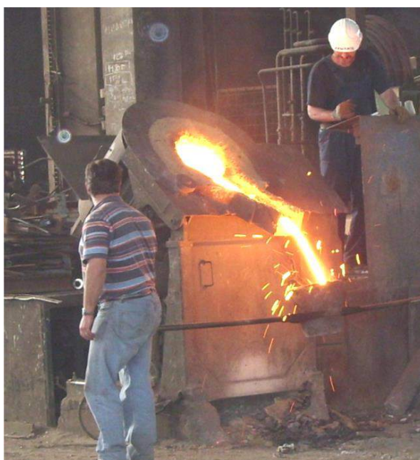
Слика 2.2. Индукциона пећ АBB типа ITMK-500
