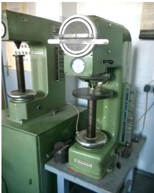
Слика 3.2. Уређај за мерење тврдоће OTTO Wolpert GmbH
