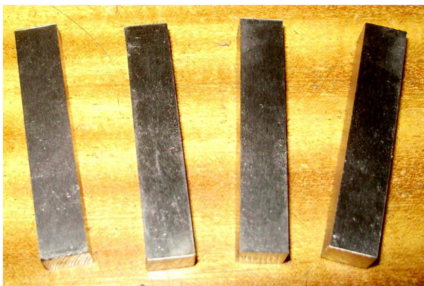
Слика 2.15. Изглед брушених епрувета за испитивање жилавости
