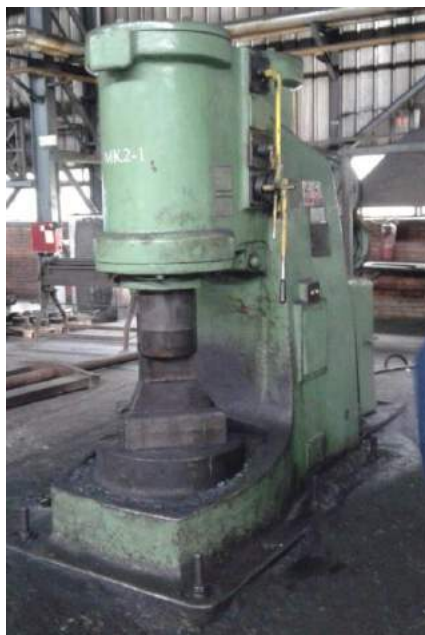
Слика 2.6. Чекић МК 2-1 који је коришћен за ковање узорака
