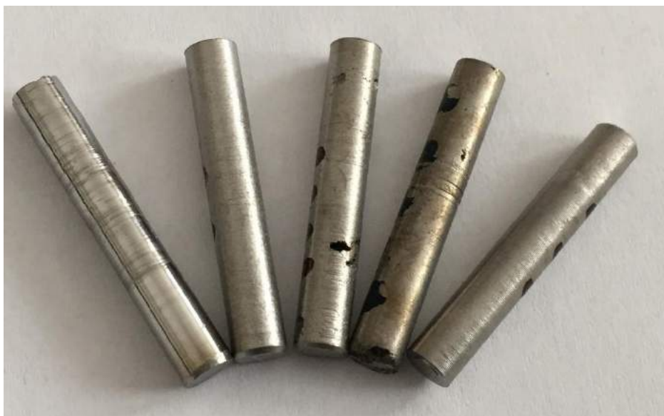
Слика 2.16. Изглед епрувета за испитивање отпорности на хабање
