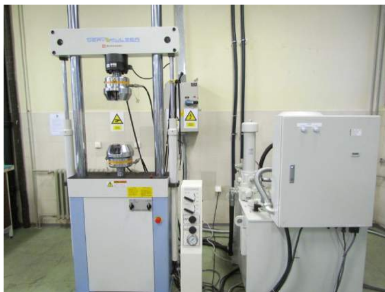
Слика 3.15. Хидраулична кидалица SHIMADZU UH-FX
