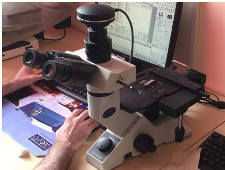
Слика 3.21. Металографски микроскоп OLYMPUS тип GX41
