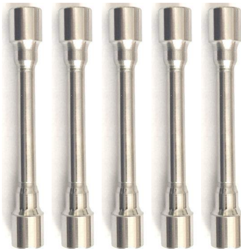
Слика 2.11. Епрувете за испитивање затезањем
