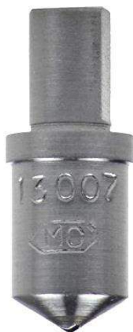
Слика 3.1. Изглед утискивача код Rockvel С методе
