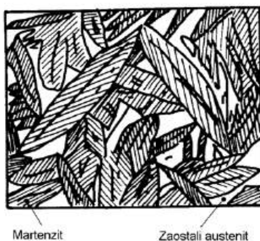
Слика 5.14. Шематски приказ микроструктуре мартензита са заосталим аустенитом
