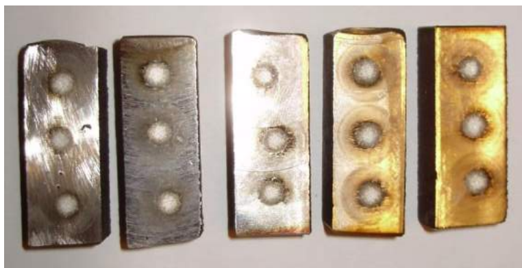
Слика 2.5. Изглед узорака после хемијске анализе спектрометром
