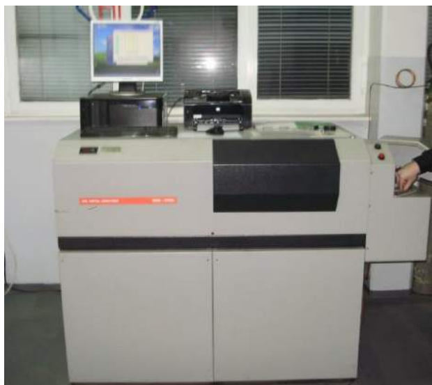
Слика 2.4. Изглед уређаја за инструменталну хемијску анализу челика ARL-3100
