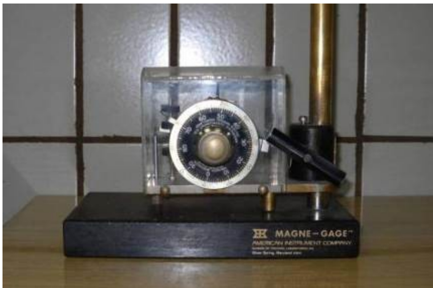
Слика 4.7 Уређај за мерење дебљине превлака
