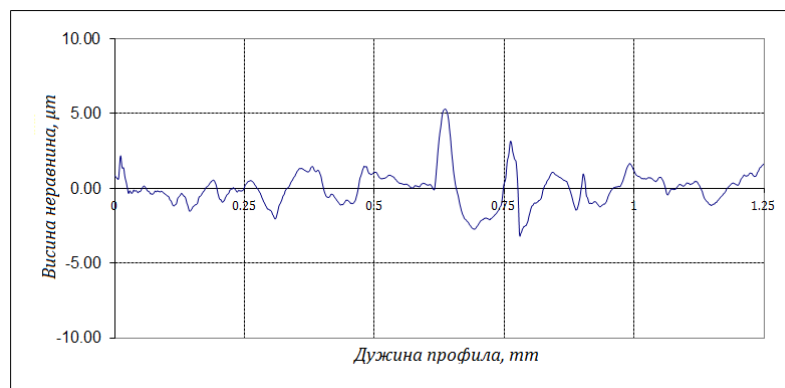
б- после наношења превлаке, Ra=0.920 \mu\text{m}
