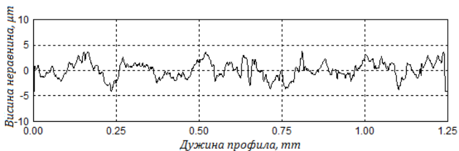
а- пре наношења превлаке Ra=0.990 \mu m
