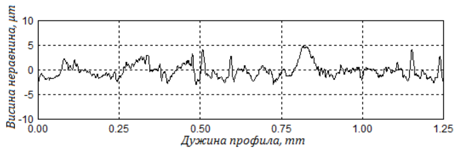
а- пре наношења превлаке Ra=1.230 \mu\text{m}
