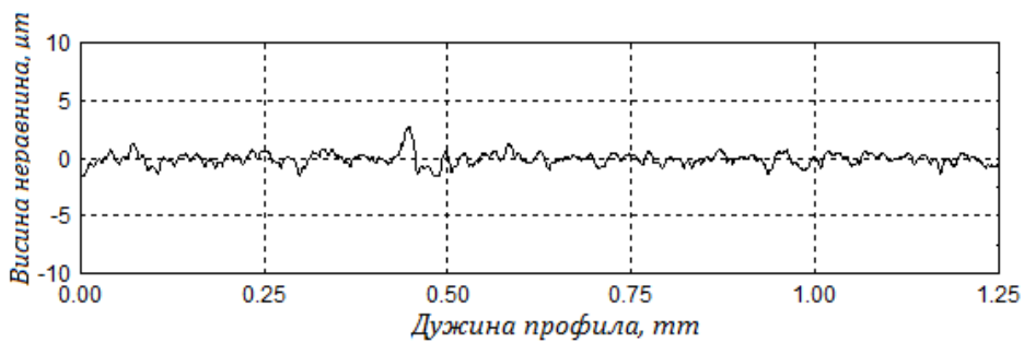
б- после nanoшења превлаке Ra=0.600 \mu\text{m}
