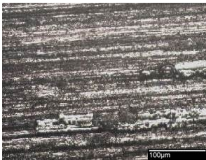
Слика 3.4 Узорак број 7, завршна обрада подлоге, грубо брушење
