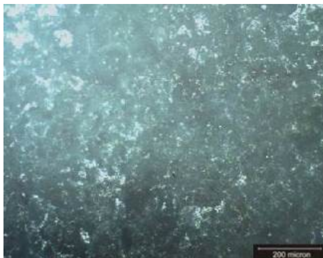
а) Изглед превлаке после 192 сата стајања у раствору NaCl
