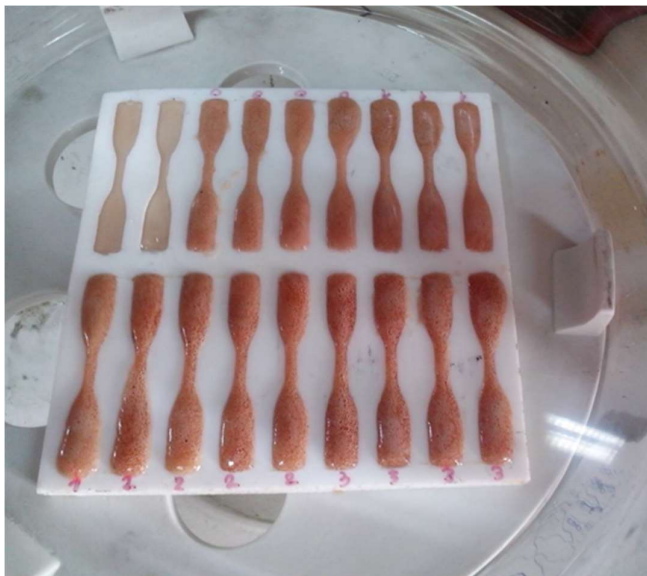
Слика 16. Узорци ојачаног композита изливени у тефлонски калуп
