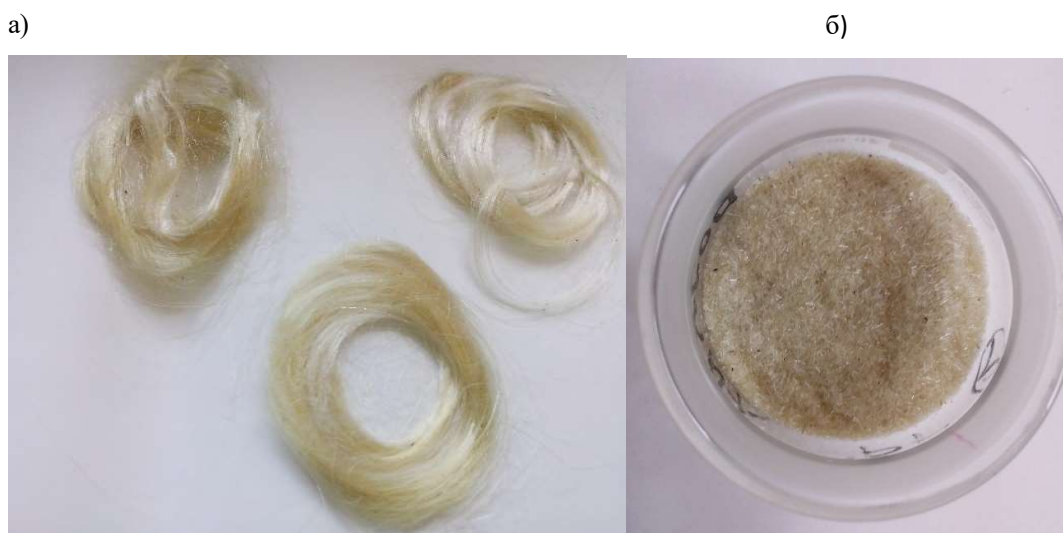
Слика 17. а) Узорци влакана добијених од рециклираног ПЕТ-а и б) Уситњена влакна добијена од рециклираног ПЕТ-а
