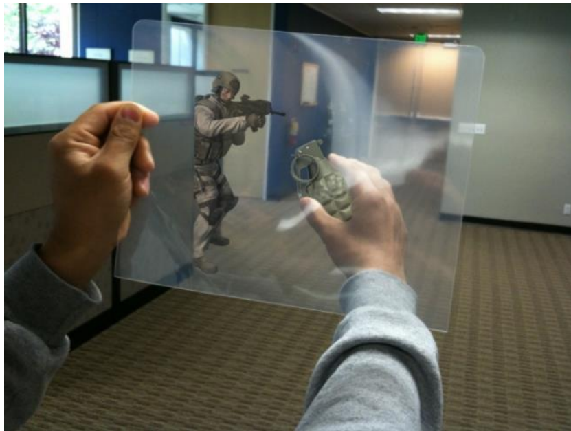
Slika 10: Optičko – prozirni ekran (Treskunov, 2012.)
