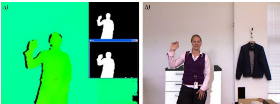
Slika 43: Funkcionisanje Kinect -a pri rešavanju problema okluzije (Siltanen, 2012)
