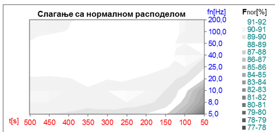
Слика 4.29 Слагање расподеле измерених вредности са нормалном расподелом у "простору мерења"
