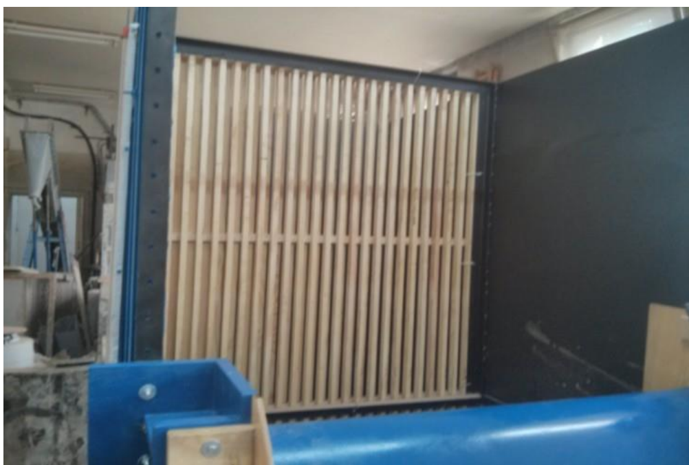
Слика 4.4 Дрвена решетка за умирење нивоа воде у резервоару
