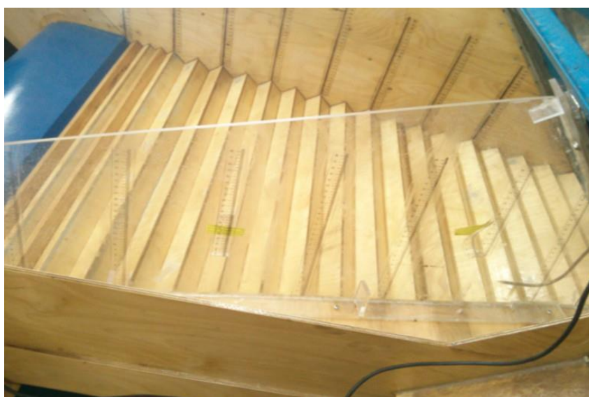
Слика 4.6 - Степенасти брзоток на ГФ моделу
