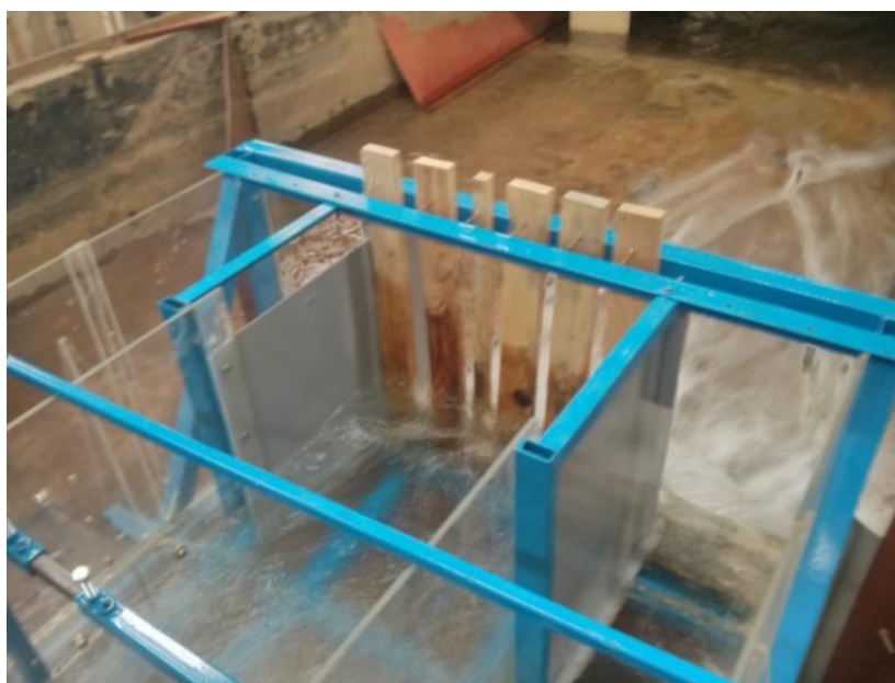
Слика 4.8 Мере за контролу низводног граничног услова
