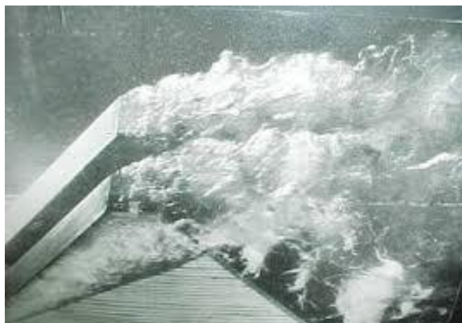
Слика 2.5 Кавитација у умирујућем базену, фотографија преузета са интернет адресе: www.usbr.gov/ssle/damsafety/risk/BestPractices/Chapters/VI-3-20150610.pdf
