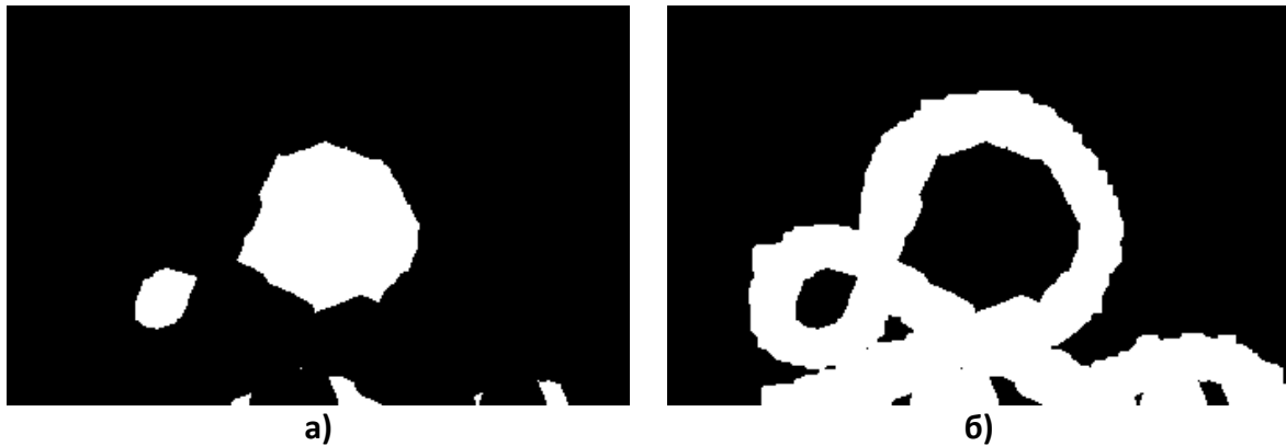
Слика 3.35 Пиксели који сигурно припадају регионима које раздвајамо а) и неодређена област у којој се налазе границе објекта б)
