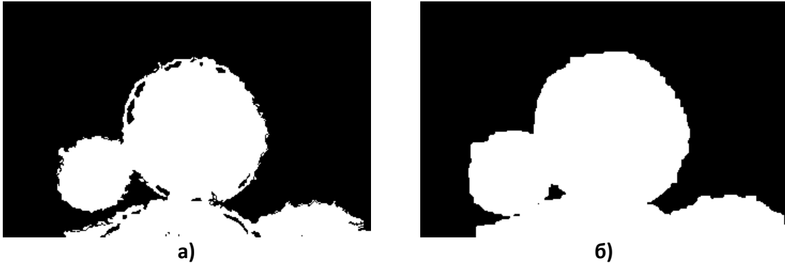
Слика 3.33 Примена морфолошког филтера дилатације б) ради проналажења пиксела позадине
