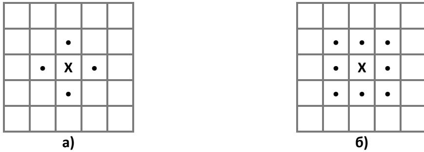
Слика 3.6 Пиксел, •, је један од суседа пиксела x који представља централни са четири везе (а) односно са 8 веза (б)
