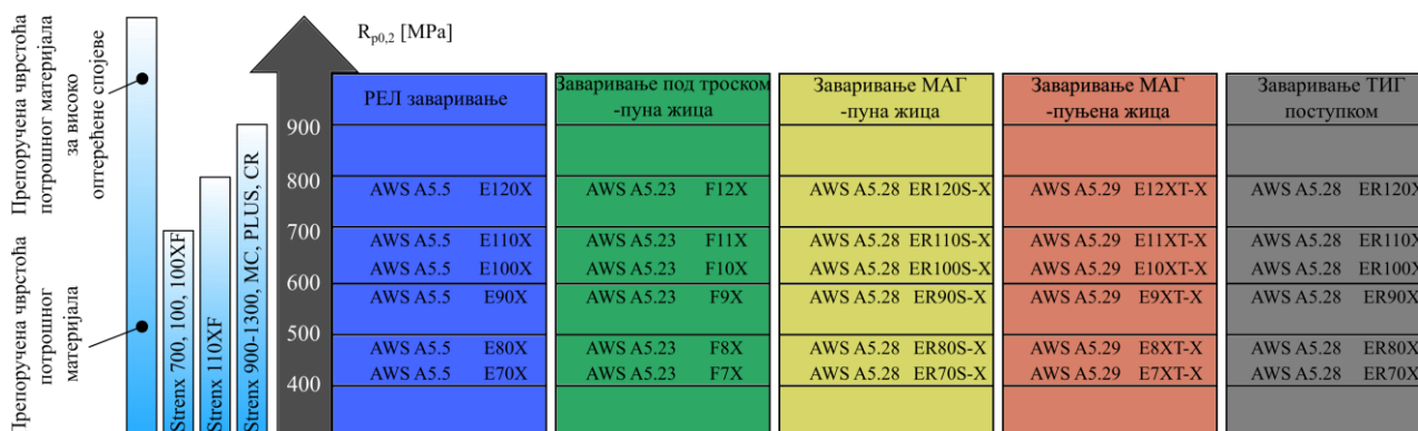
Слика 4.4 Препорука произвођача о избору додатног материјала од аустенитног нерђајућег челика [89]
