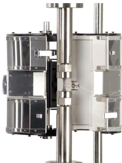
Слика 5.12 Дводелна комора за испитивање на повишеним температурама
