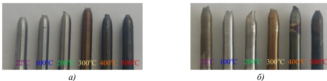
Слика 7.51 Преглед епрувета након испитивања: а) Епрувете од основног материјала и б) епрувете са завареним спојем
