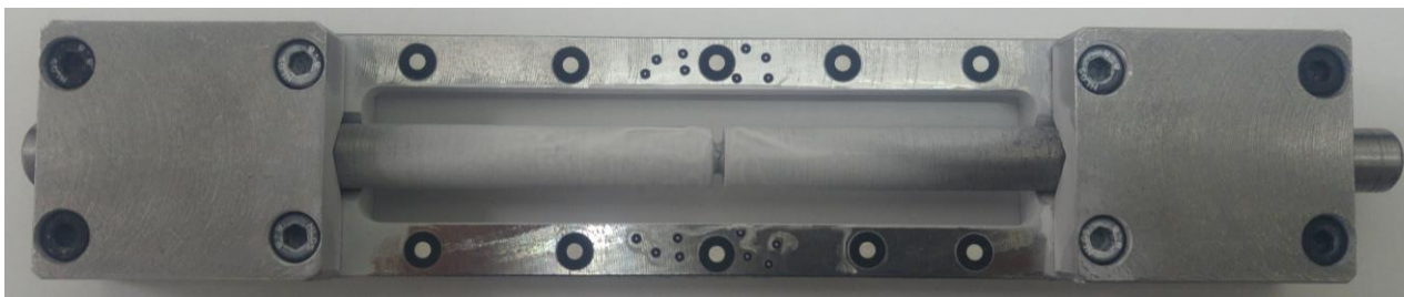
Слика 7.25 Позиционирани и стегнути делови односиметричне епрувете са зарезом R0,8 у алату
