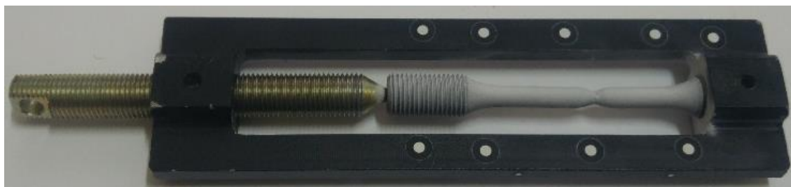
Слика 7.65 Стезни алат за довођење у контакт раздвојених делова епрувете преко преломних површина
