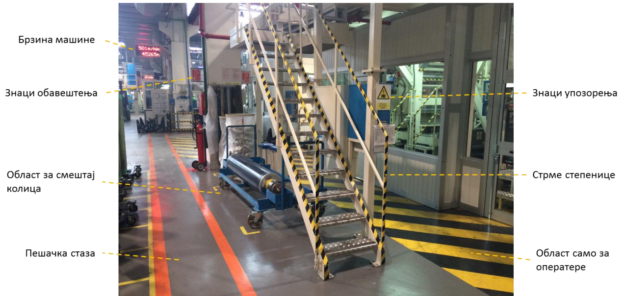
Слика 6.8 Примена 5С концепта у предузећу Тетра Пака у циљу унапређења безбедности радног окружења
