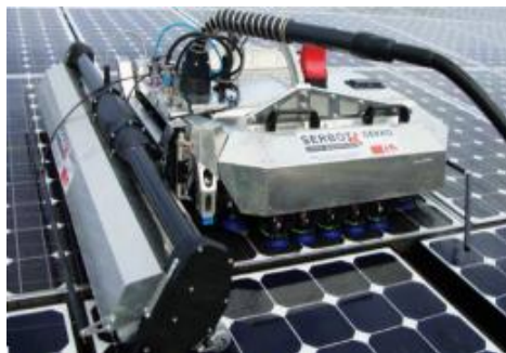
Slika 2.5. Čišćenje solarnih modula mehaničkim sistemom sa četkicama
