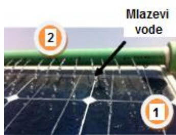
Slika 2.4. Sistem sa mlaznicama: 1) solarni modul, 2) cevovod sa mlaznicama
