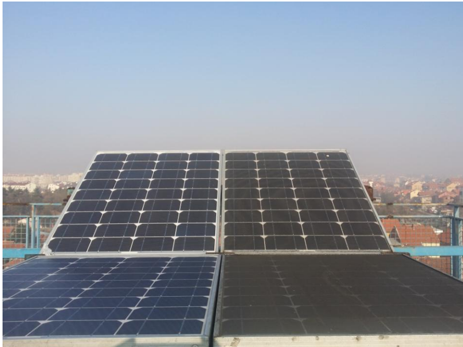
Slika 3.128. Čisti (levo) i solarni moduli zaprljani nataloženom čađi (desno)
