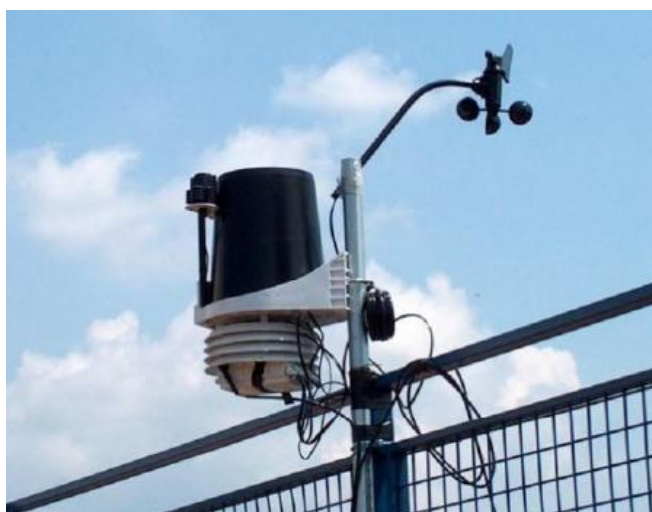
Slika 3.4. Automatska meteorološka stanica DAVIS Vantage Pro na Prirodno-matematičkom fakultetu u Nišu
