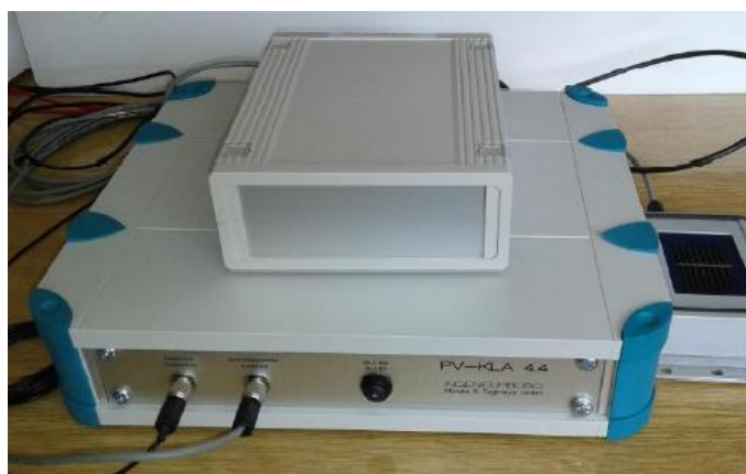
Slika 3.5. PV-KLA uređaj, Ingenieurburo Mencke&Tegtmeyer, Nemačka
