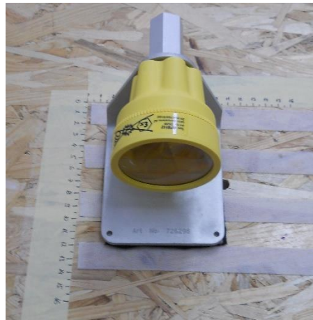
Slika 57: Geodetska prizma za monitoring postavljena na panel
