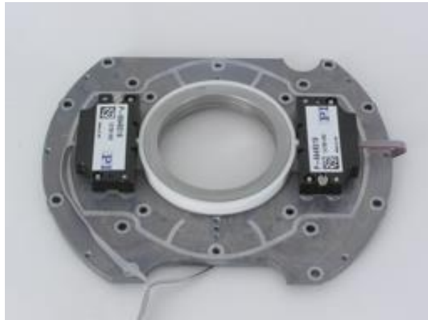
Slika 12: Direct-drive motori za pokretanje robotizovane totalne stanice, bazirani na piezo efektu
