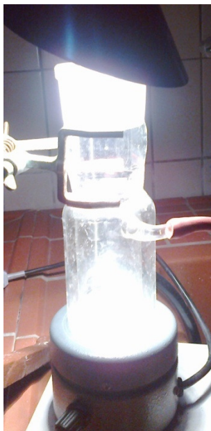
Slika 25. Izgled hemijskog reaktora postavljenog na mešalicu i osvetljenog OSRAM 50 W halogenom lampom za izvođenje foto-Fentonovog eksperimenta.
