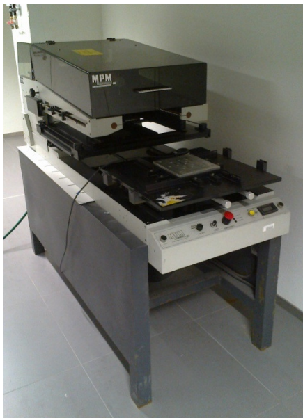
Slika 23. Mašina za štampanje elektroda „screen printing” postupkom, Karl Franzens Univerzitet u Gracu, Austrija, laboratorija prof. dr Kurt Kalhera.
