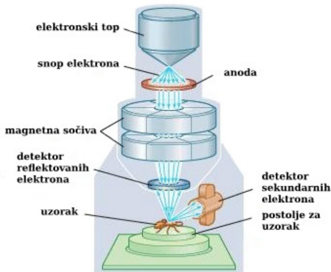
Slika 12. Šema skenirajućeg elektronskog mikroskopa [191].
