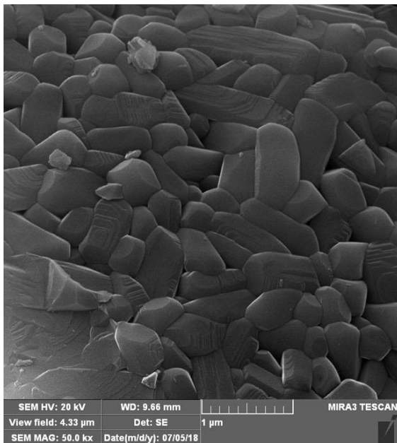
Слика 28. Скенирајуће електронске микрографије прахова прекурсора допитраног мулита са 9 мас% \text{Fe}_2\text{O}_3 , термички третираног на 800\text{ }^\circ\text{C} у току 4 сата
