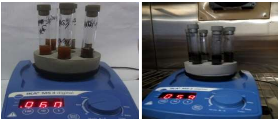
Слика 3.1. Имобилизација \alpha -амилазе мешањем на орбиталном шејкеру у термостату
