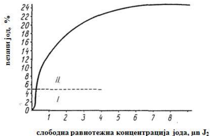
Слика 2.4. Сорпциона изотерма скробно-јодног комплекса [21]
