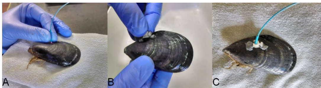
Slika 3.8. A) Traženje signala, B) Lijepljenje držača za senzor, C) dagnja sa povezanim senzorom
