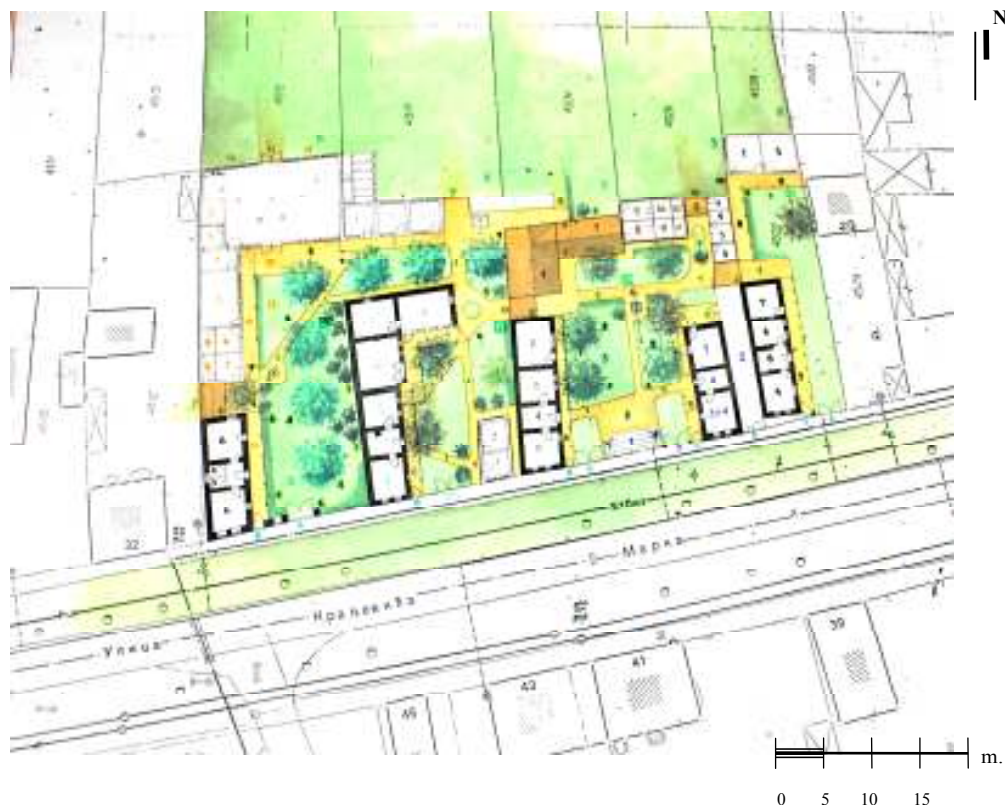
Слика 5.2: Урбана Матрица у Војводини. Слободностојећи објекти на пространој парцели, несметана инсолација и проветравање
