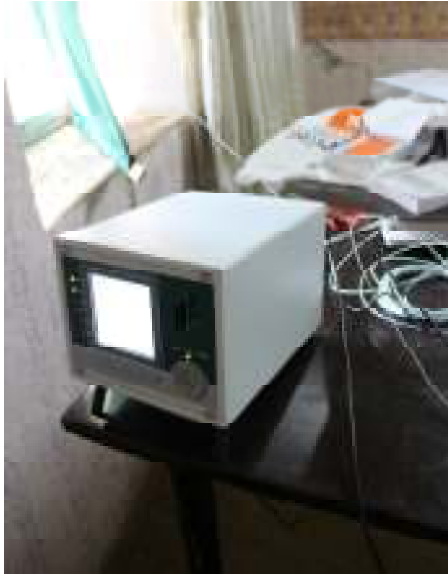
Слика 7.1: Уређај ALMEMO 5690-2 /ahlborn , подаци на монитору уређаја се могу очитати у реалном времену
