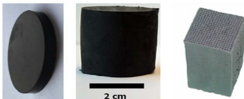
Slika 3. Različiti oblici karbon monolita: tableta, sunderasta struktura i paralelopiped (Vukčević, 2013)
