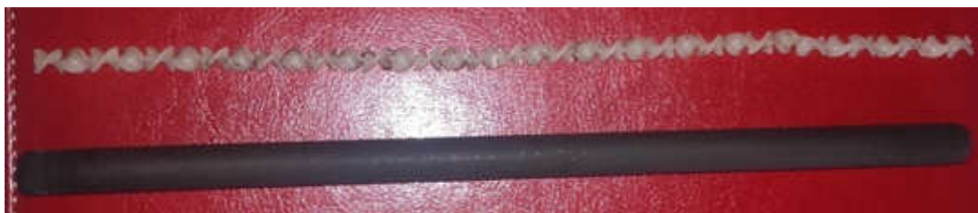
Slika 3.2. Fotografija Carbosep M7 membrane i Kenics statičkog mešača (promotora turbulencije)
