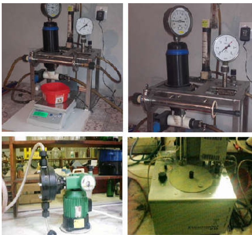
Slika 3.5. Fotografije eksperimentalne aparature upotrebljene za ispitivanje kinetike prenosa mase model rastvora voćnih sokova.
