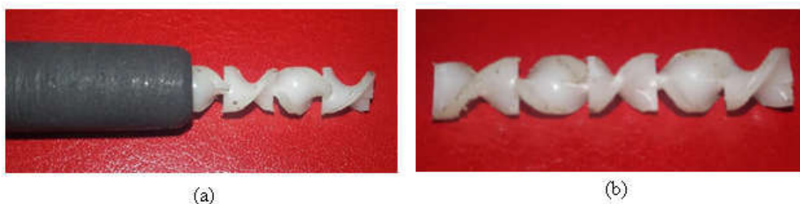
Slika 3.3. (a) Fotografija Carbosep membrane i promotora turbulencije; (b) fotografija Kenics statičkog mešača
