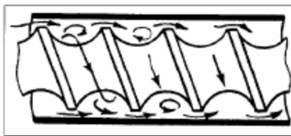
Slika 1.13. Statički generatori turbulencije odnosno vrtloga unutar cevaste membrane
