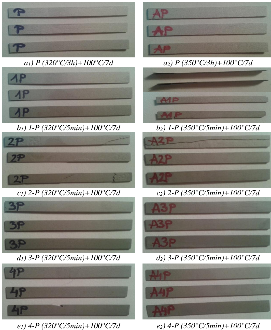
Slika 3.71 (a 1 -e 2 ) Makroizgled senzitivizovanih štanglica modifikovane AA083+Zn legure nakon NAML testa.
