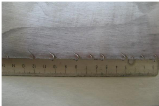
c) Pojava ivičnih prslina u drugom provlaku
