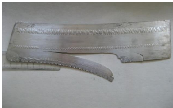
d) Pojava uzdužne prsline u šestom provlaku
