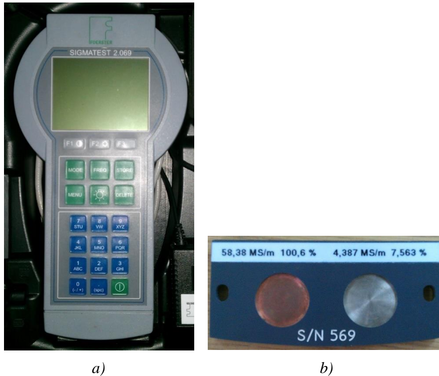
Slika 2.9 Uređaj za merenje provodljivosti a) i etalon za kalibraciju uređaja b).
