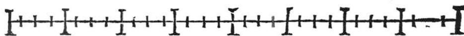
Цртеж 9: Серилијев приказ половине стопе у античком Риму, као почетак размерне линије. Извор: Paul Emmons, “Size matters: Virtual scale and bodily imagination in architectural drawing,” Arq: Architectural Research Quarterly 9, no. 3–4 (2005): 227.
