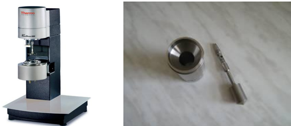
Slika 14. RheoStress 600, Haake i pribor koji se koristi reološkoj analizi masnih masa
