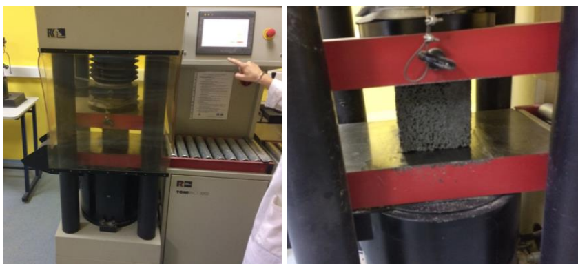
Слика 4.7 Одређивање чврстоће при притиску
