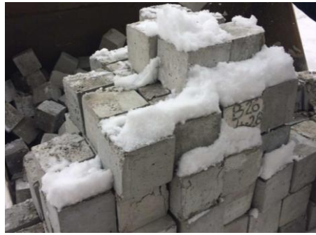
Слика 4.1 Контролне бетонске коцке
