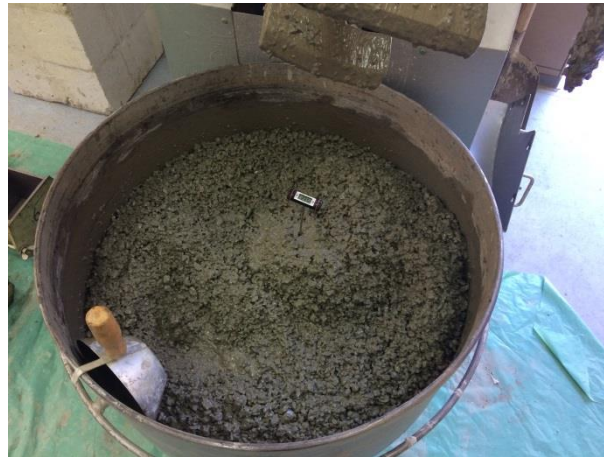
Слика 4.4 Справљање бетонске мешавине
