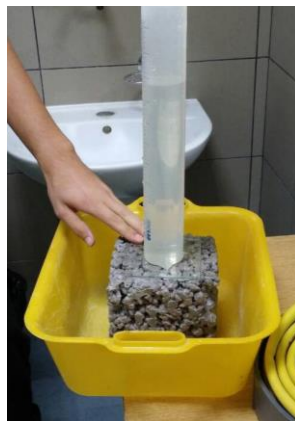
Слика 4.12 Одређивање коефицијента водопроницаемости
