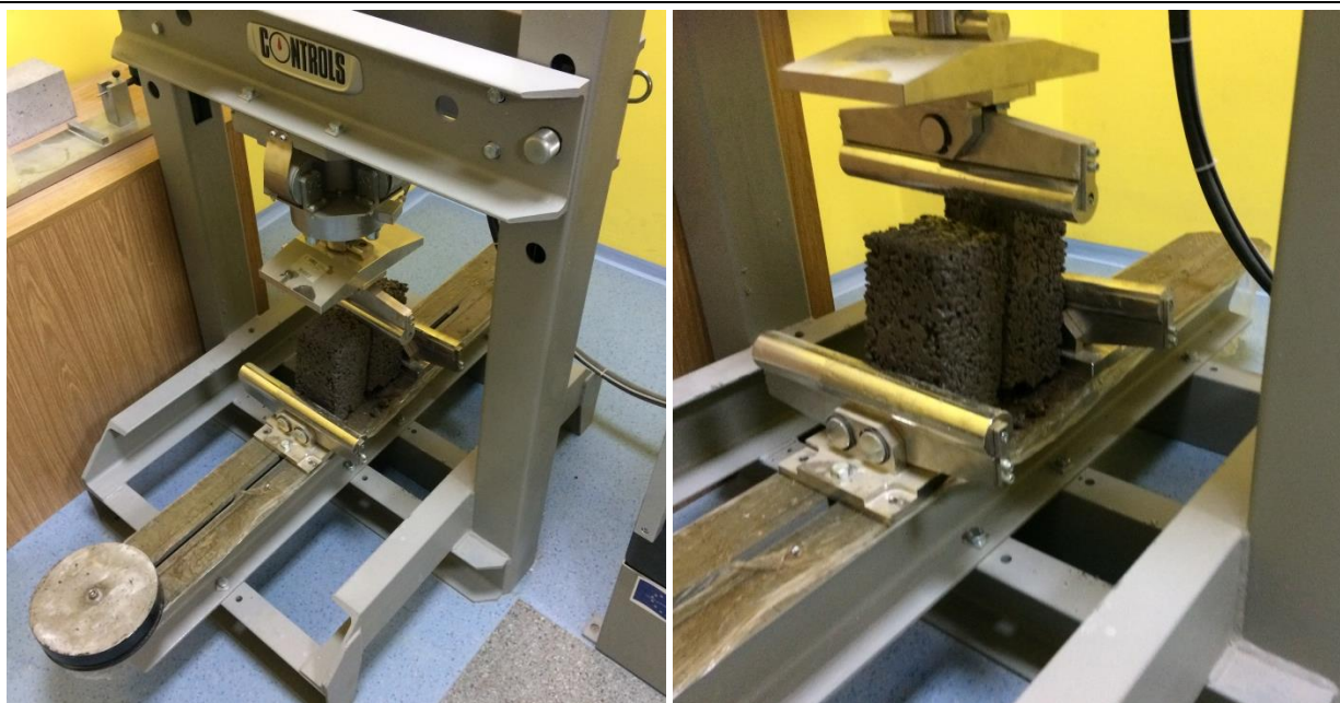
Слика 4.8 Одређивање чврстоће бетона при савијању
