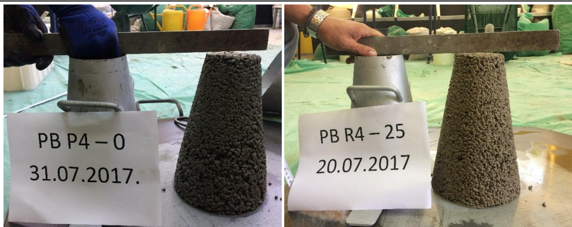
Слика 4.6 Мерење конзистенције методом слегања за бетоне PB P4-0 и PB R4-25
