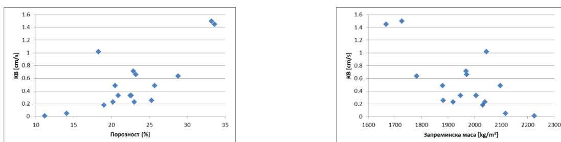
Слика 3.33 Зависност између коефицијента водопропустљивости и порозности (лево); зависност између коефицијента водопропустљивости и запреминске масе очврслог бетона (десно) [9]
