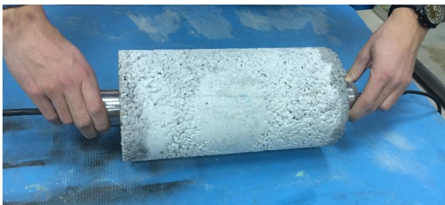
Слика 4.11 Одређивање динамичког модула еластичности
