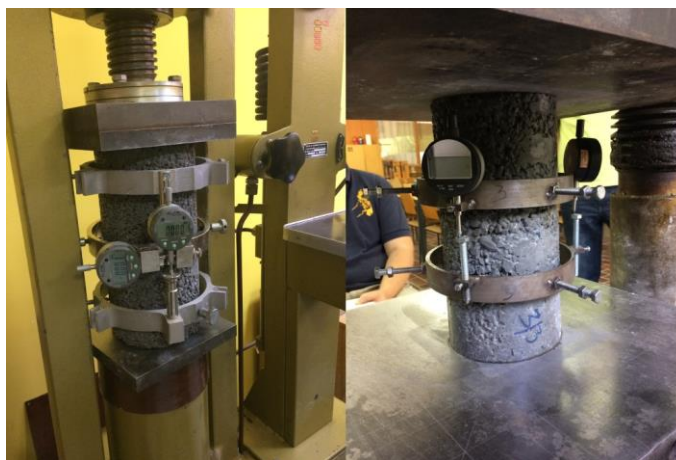
Слика 4.10 Одређивање статичког модула еластичности
