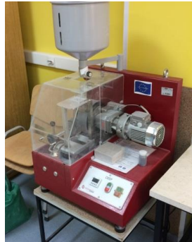
Слика 4.9 Испитивање хабања помоћу широког точка
