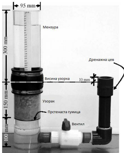
Слика 2.23 Уређај за мерење порозности порозног бетона [40]
