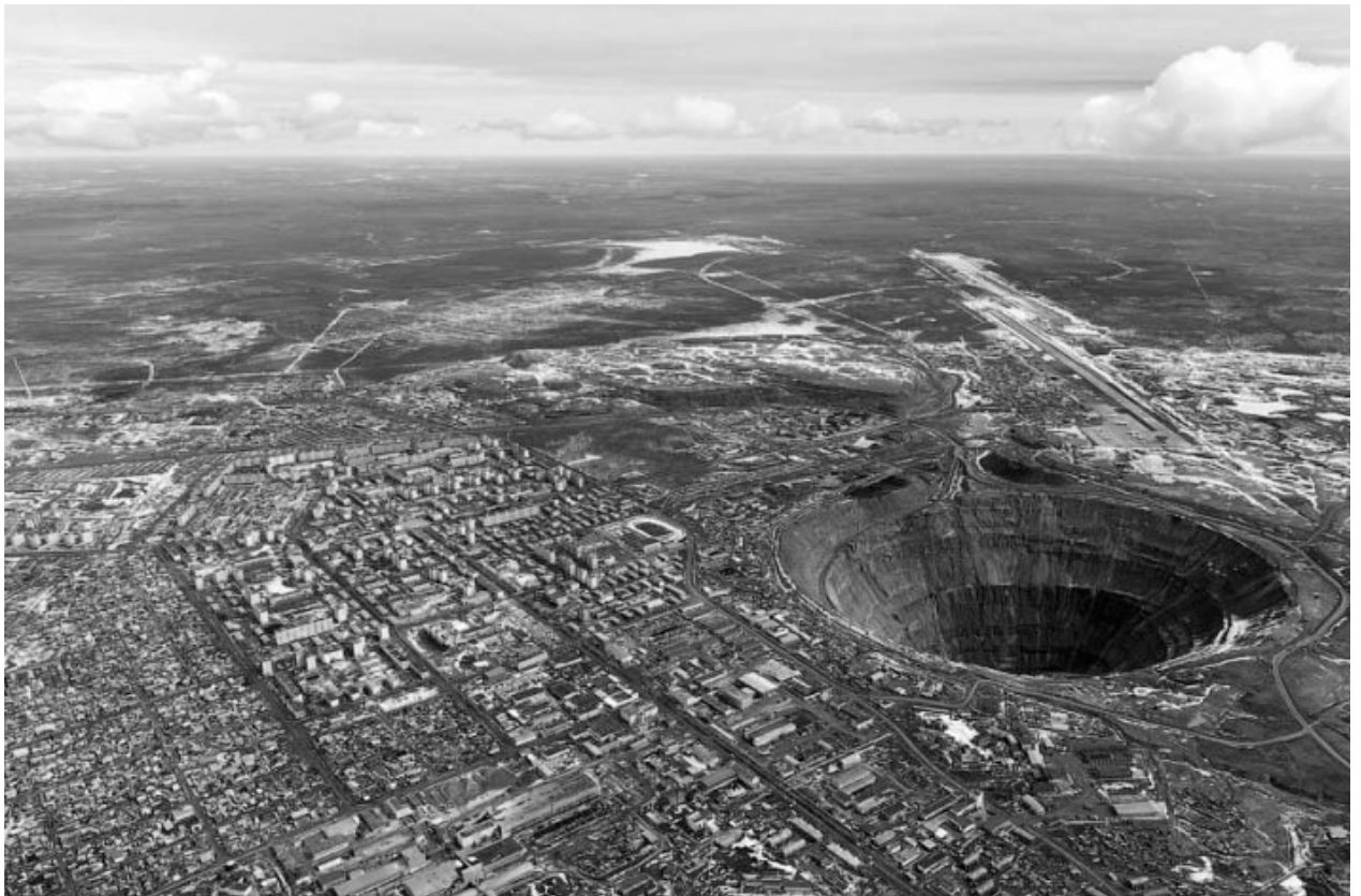
Slika2. Mirni, Sibir, grad čija se ekonomija mahom zasniva na rudniku dijamanta. Otvoreni kop je dostigao prečnik od 1.5 kilometara i dubok je oko 600m, i postao dramatična pejzažna anomalija. Pri tom dragoceni produkt koji se dobija u retkim sićušnim kristalima izdvojenim iz ogromne količine rude nije ni neophodna sirovina, ni energent koji bi mogli koristiti za funkcionisanje gradskih procesa, već zahvaljujući jedinstvenim perceptualnim svojstvima, svojoj tvrdoći i pogotovo retkosti, dijamant postiže veliku, gotovo magičnu privlačnost a time i visoku ekonomsku vrednost.
