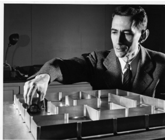
Slika 10. Šenonov elektromehanički miš, jedan od prvih uređaja koji je samostalno rešavao problem snalaženja u prostoru. Miš je imao zadatak da sa početne pozicije stigne do zadatog cilja krećući se u ortogonalnom lavirintu čije su se pregrade mogle proizvoljno postavljati i uklanjati. Miš je u stvari elektromagnet koji je putem magnetnog polja pokretan mehanizmom koji se nalazio ispod table. Ovaj mehanizam je putem miša registrovao prepreke na putu i moguće prolaze i slepe završetke gradeći memorisanu predstavu pređenih polja da bi usmerio elektromagnet prema cilju. Videti Claude Shannon Demonstrates Machine Learning.
