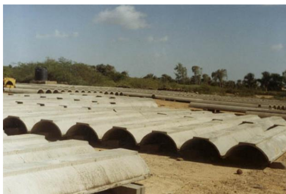
Слика 74. TARA фероцементни елементи. [Преузето са http://taramachines.com/TARA-GreenCastChannel.aspx , 25.5.2012.]
