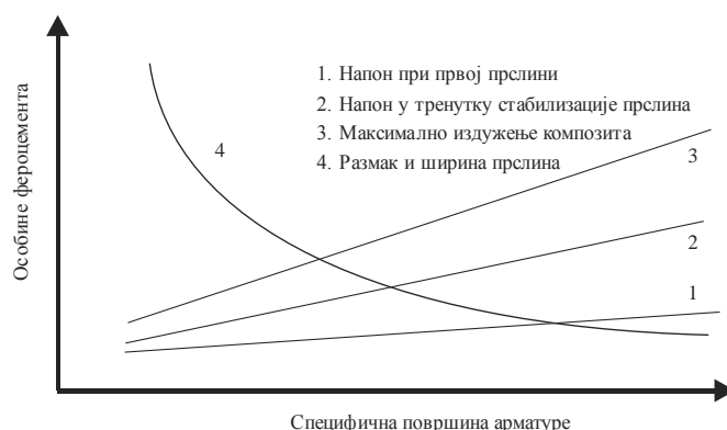
Слика 59. Утицај специфичне површине арматуре на особине фероцемента. [Извор: А.Е. Naaman, Ferrocement and Laminated Cementitious Composites (Ann Arbor: Techno Press 3000, 2000), 36]
