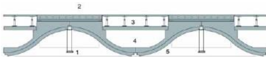
Слика 13. Попречни пресек кроз синусоидну међуспратну таваницу – 1-светилке, 2-слој са уграђеним системом за грејање и хлађење, 3-подигнути под, 4-вентилациони канал, 5-префабриковане таласасте бетонске љуске са слојем бетона ливеног на лицу места; зграда организације BRE, Гарстон, УК, 1996., архитектонско решење Фајлден Клег Бредли Архитекти. [Извор: Fielden Clegg Architects]
