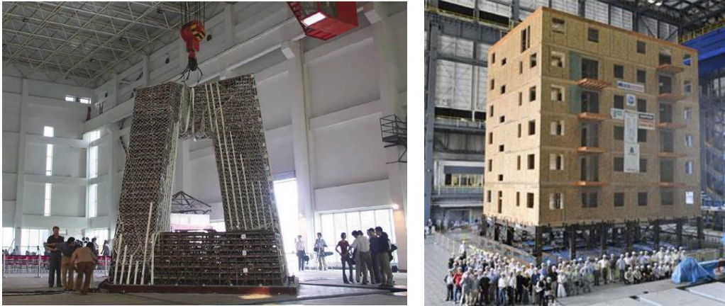
Слика 16. Модел конструкције зграде седишта CCTV-а, израђен за потребе тестирања перформанси конструкције при дејству земљотреса; фаза реализације пројекта; Пекинг, Кина. [Извор: С. Carroll, P. Cross, X. Duan, C. Gibbons, G. Ho, M. Kwok, R. Lawson, A. Lee, R. Li, A. Luong, R. McGowan, and Pope, „Case Study: CCTV Building - Headquarters & Cultural Center“, CTBUH Journal , 2008, 3]
