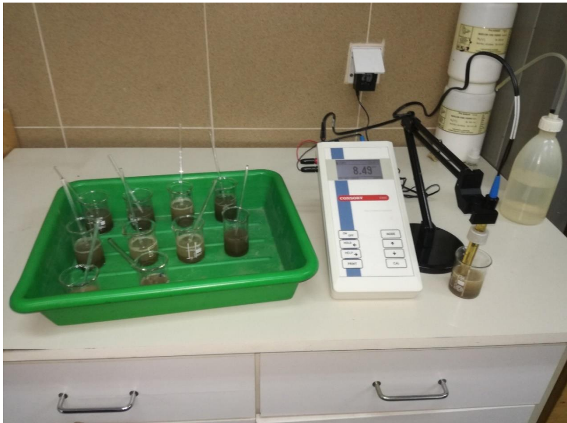
Слика 6.15. Одређивање рН вредности земљишта
