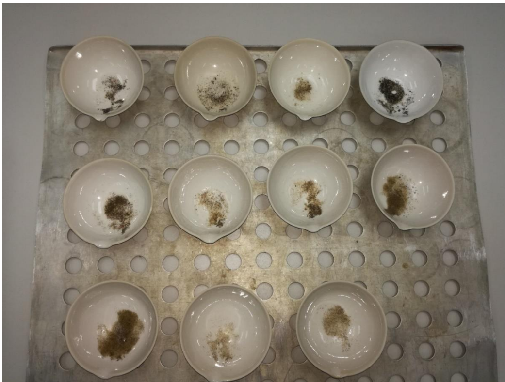
Слика 6.16. Припрема узорака за анализу – механички састав (песак)
