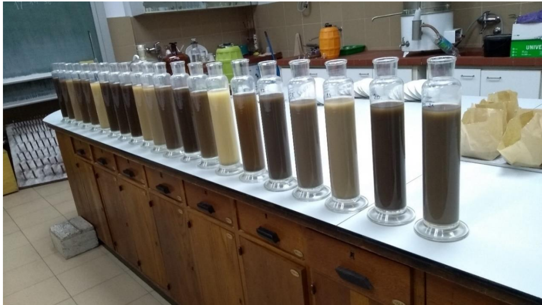
Слика 6.14. Припремљени узорци за механичку анализу
