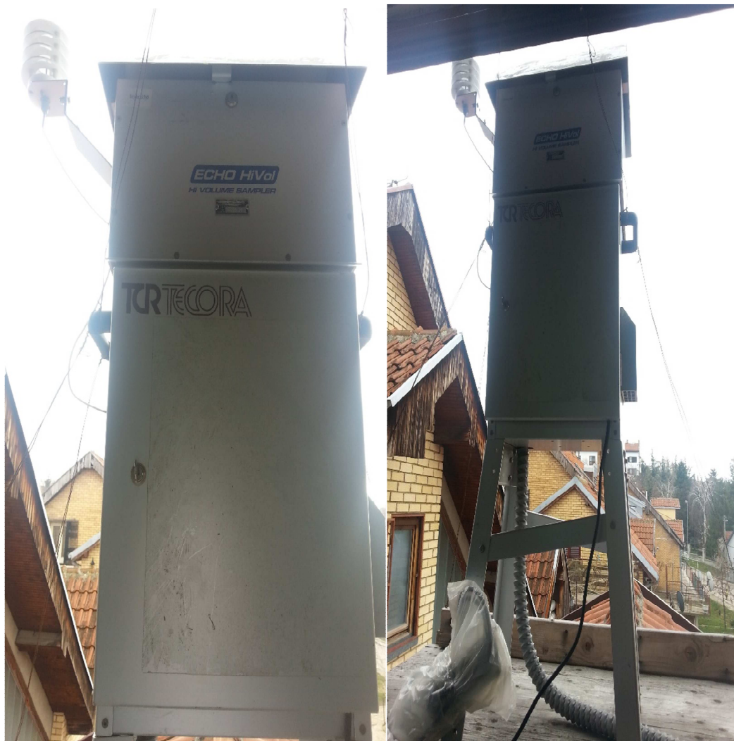
Slika 4.1. Automatski uzorkivač TCR Tecora korišćen u radu
