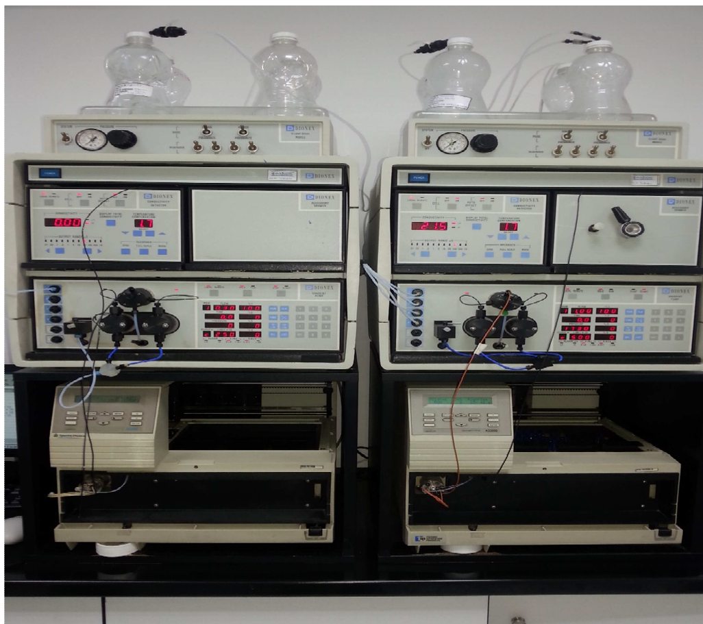
Slika 4.2. Jonski hromatograf DIONEX DX300 korišćen u radu
