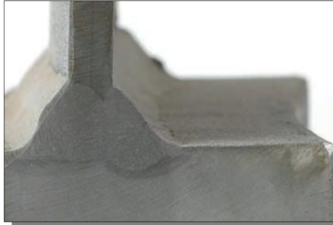
Slika 3.12 Zaobljenje u korenu kod T-spoja dobijenog FSW postupkom (Ilustracija preuzeta iz [24])
