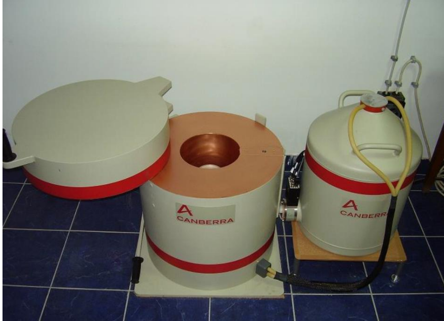
Слика 7.2 – Оловна заштита са системом за хлађење. Слика преузета из (75) .
