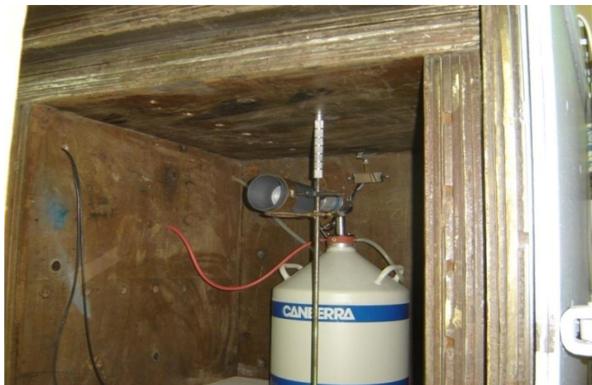
Слика 7.1 – Експериментална поставка детектора у гвоздној заштити. Слика преузета из (75).
