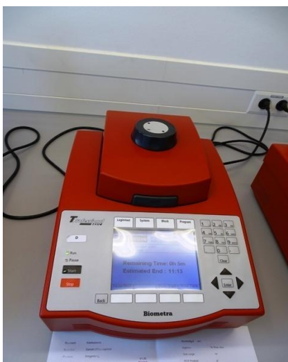
Slika 21. PCR uređaj u postupku DNK amplifikacije (foto: Cvjetković, 2015)
