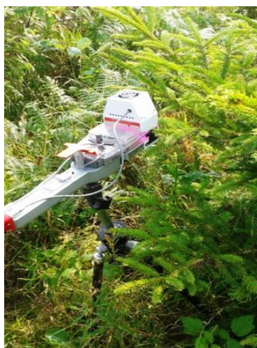
Slika 11. Mjerenje fotosinteze, stomatalne provodljivosti i transpiracije uređajem LCpro+ (foto: Cvjetković, 2016)
