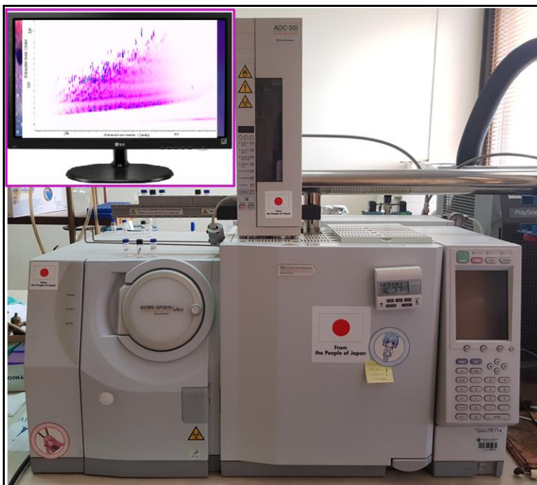
Slika 16. Dvodimenzionalni gasni hromatograf sa masenim spetrometrom (GCxGC-MS; Univerzitet u Beogradu, Hemijski fakultet, Katedra za biohemiju).
