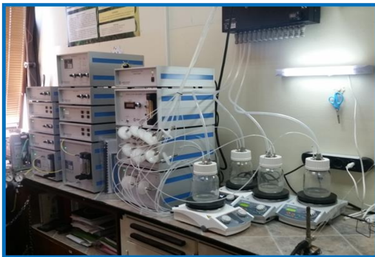
Slika 17. Micro Oxymax ® respirometar (Univerzitet u Beogradu, Hemijski fakultet, Katedra za biohemiju).
