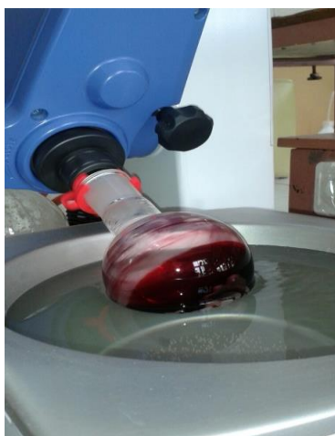
Slika 6. Uparavanje metanolnog ekstrakta ploda M. nigra na vakuum uparivaču
