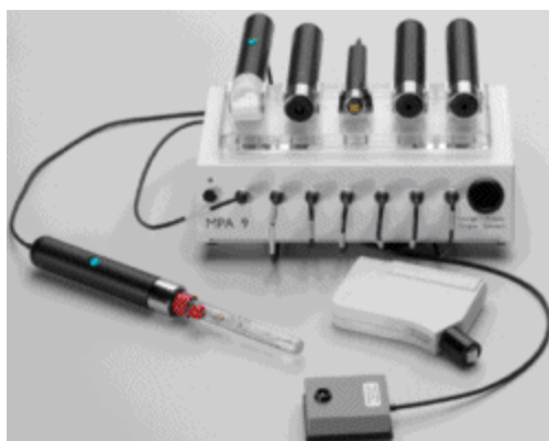
Slika 9. Multi Probe Adapter MPA R9 za neinvazivna biofizička merenja
