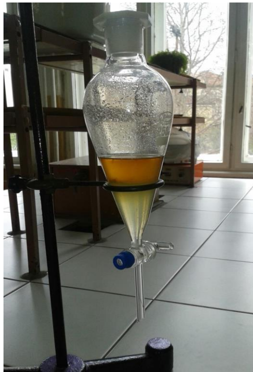
Slika 8. Ekstrakcija aglikonskog dela metanolnog ekstrakta ploda M. nigra u ekstrakcionom levku
