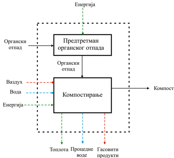
Слика 2.7 Блок шема токова отпада и емисија приликом компостирања
