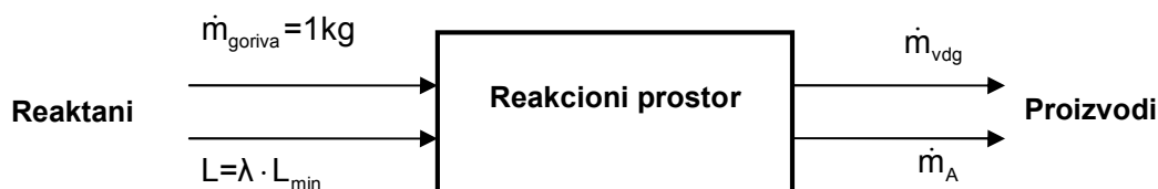
Slika 4.15. Šematski prikaz materijalnog bilansa procesa sagorijevanja OAP
