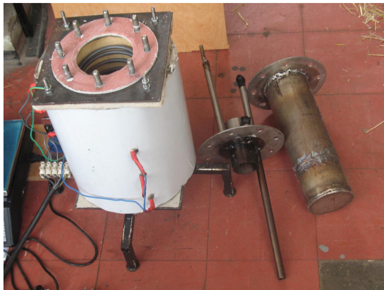
Slika 6.8. Reaktor za pirolizu
