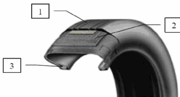
Slika 4.1. Struktura OAP [1] (1.gazeći sloj, 2. tijelo, 3. peza (stopa))
