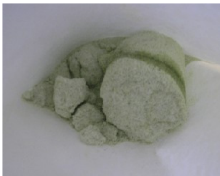
Slika 37. Fotografija usitnjenog semena tikve golice srednjeg prečnika 0,24 mm nakon 8 h ekstrakcije u većem ekstraktoru. Na fotografiji se vidi deo materijala u sloju koji je ostao neizekstrahovan zbog pojave kanala u sloju formiranih usled velikog stepena usitnjenosti čestica.
