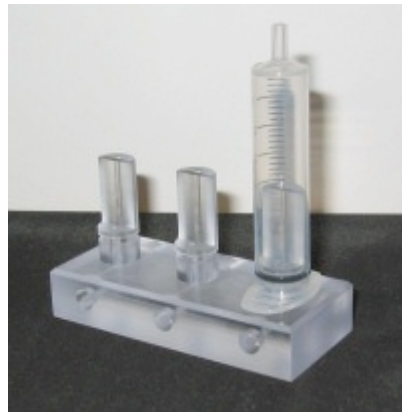
Slika 8. Protočna ćelija (A) i hvatač mehurića vazduha (B) ( www.csm.bio.dtu.dk/Instrument%20Center/Resources/Biofilm%20Setup.aspx )
