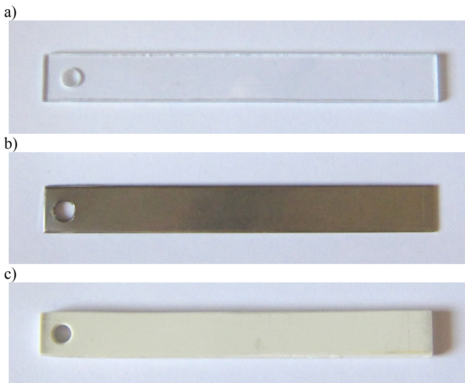
Slika V. Izgled test-pločice od (a) polikarbonata, (b) nerđajućeg čelika i (c) polivinil hlorida
