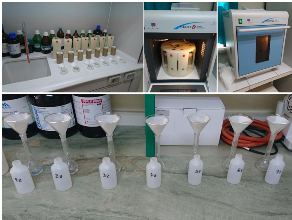
Slika 4.3.1.2. Priprema matičnih rastvora mikrotalasnom digestijom (foto: V. Vuksanović)
