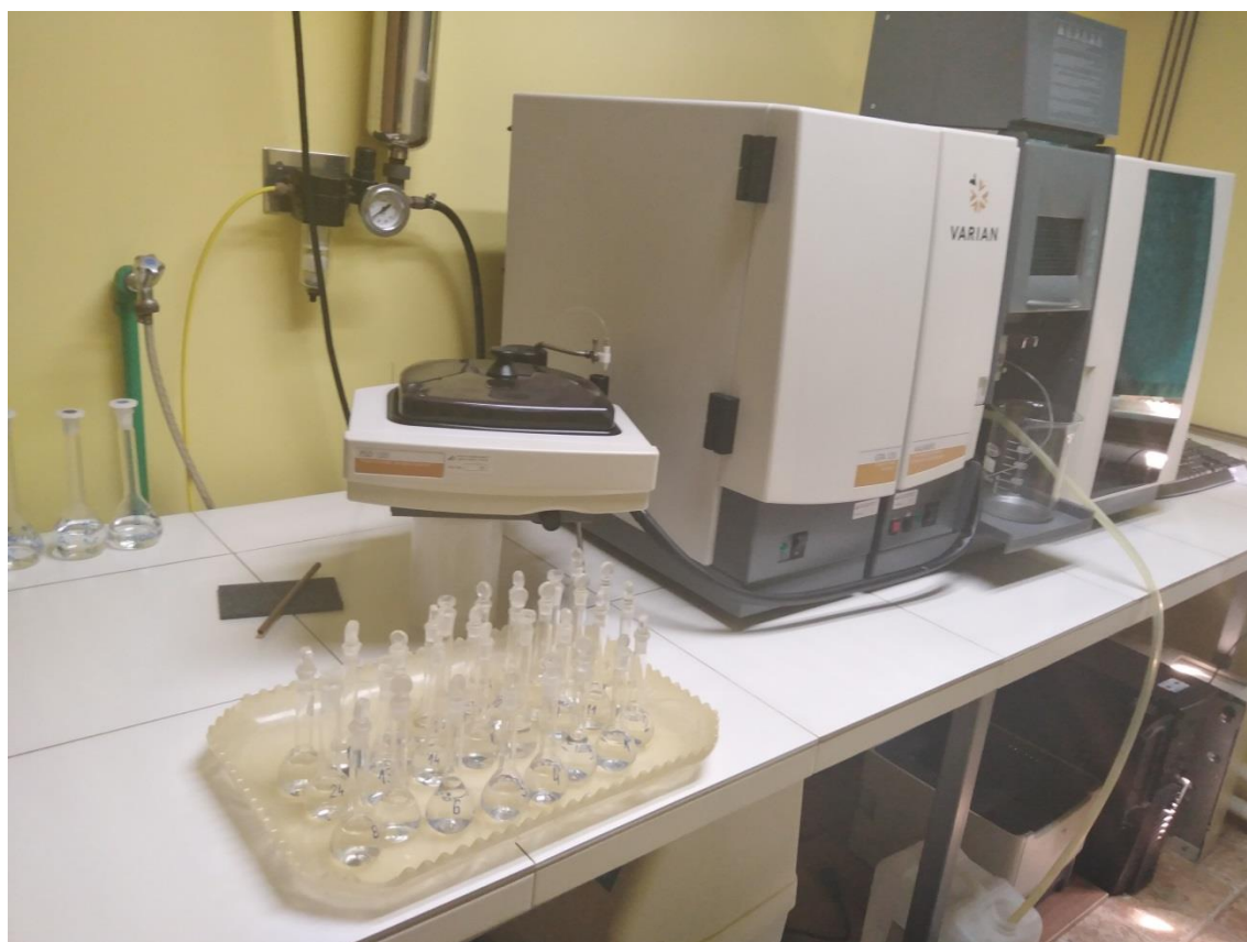
Slika 4.4.3.1. Priprema uzoraka za atomsku apsorpcionu spektrofotometriju (foto: V. Vuksanović)
