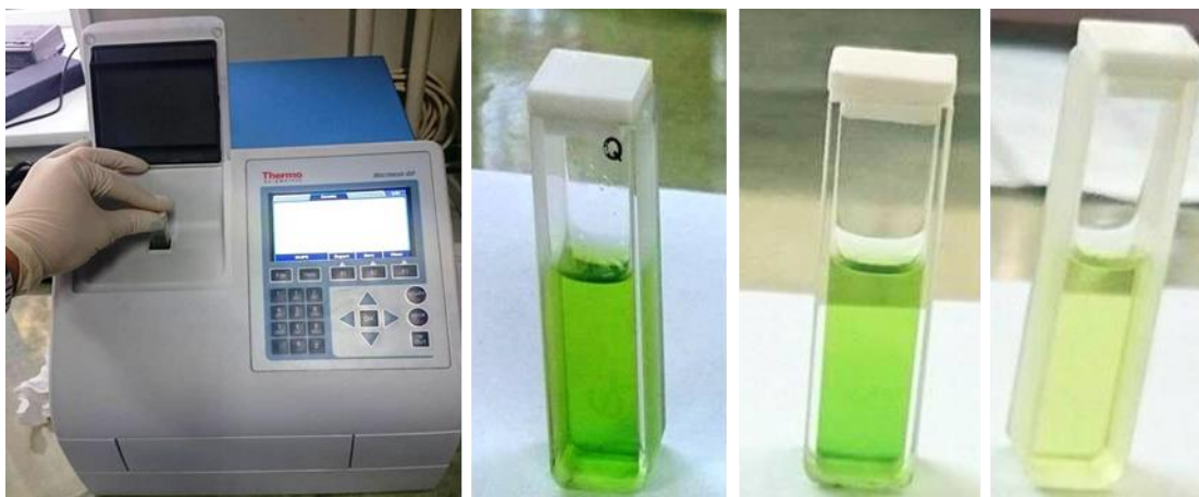
Slika 4.4.2.1. Merenje fotosintetičkih pigmenata pomoću spektrofotometra (foto: V. Vuksanović)
