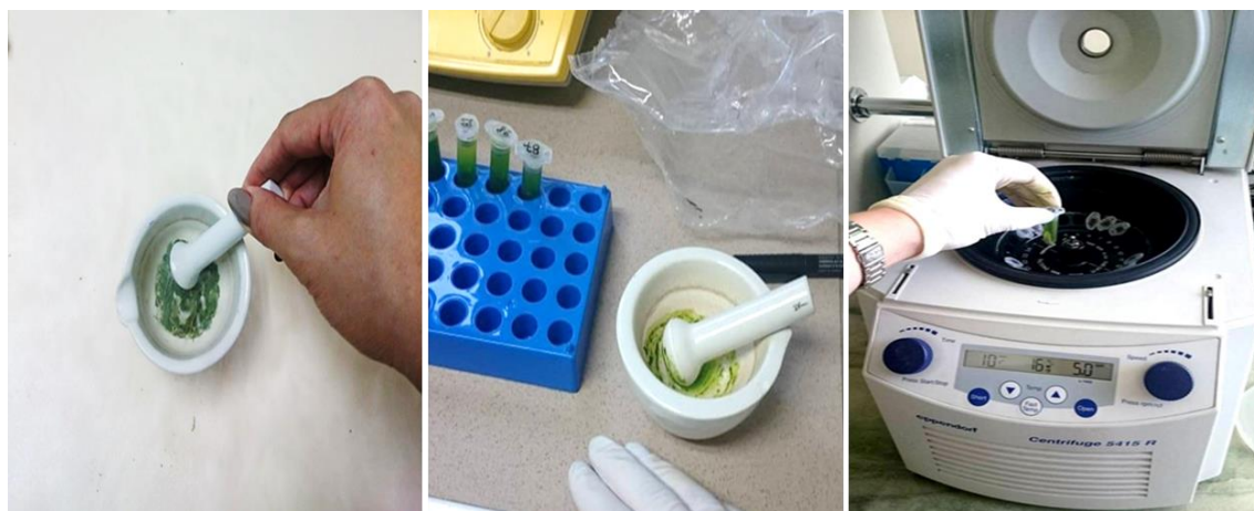
Slika 4.3.1. Priprema etanolinog ekstrakta (foto: V. Vuksanović)
