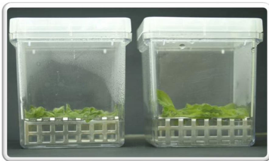
Slika 7. Prikaz postavke eksperimenta dehidracije/rehidracije: eksplantati se nalaze u otvorima čeličnih nosača u Magenta kutijama i naliven je odgovarajući medijum: levo je dodat medijum sa dodatkom PEG 8000 ( \psi = -2 MPa), desno medijum bez dodatka PEG 8000
