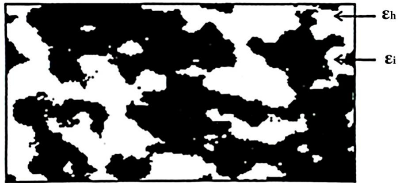
Slika 3.4: Šematski prikaz smeše na koju se primenjuje Bruggeman – ova aproksimacija. \epsilon_i – permitivnost i - te inkluzije, \epsilon_h – permitivnost domaćina
