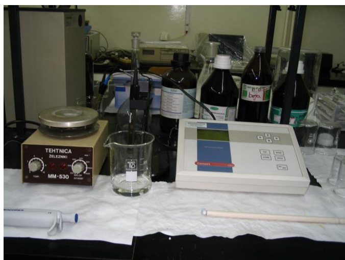
Slika 5.1 pH-jon metar za merenje koncentracije jona jon-selektivnim elektrodama u ovom radu
