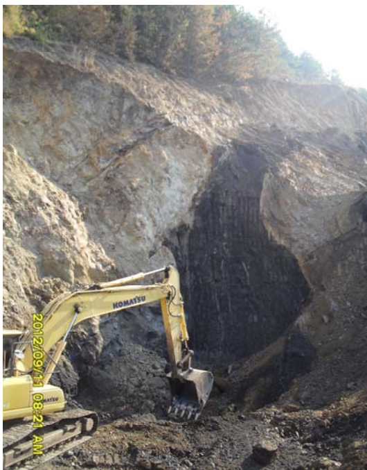
Slika 74. Otkriveni sloj uglja na površinskom kopu „Progorelica“-ibarski rudnici (foto: B.Miladinović)
