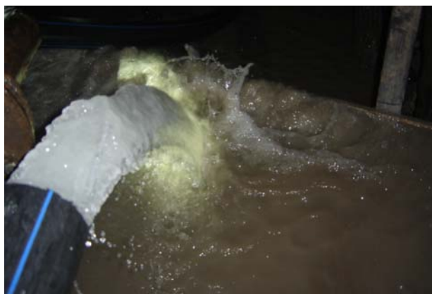
Slika 175. Vodosabirnik VS-802 (k.790) u jami rudnika "Štavalj" u kome se gravitaciono prikupljaju rudničke vode (oktobar 2011., foto B.Miladinović)
