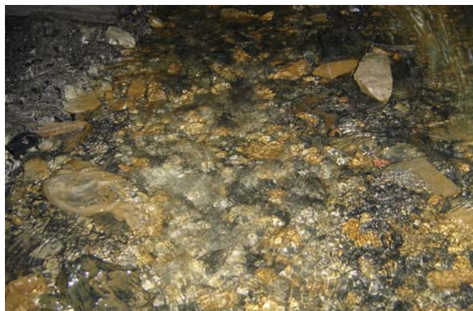
Slika 176. Priliv rudničkih voda Q \approx 20 l/s iz starih rudarskih radova OH-810 (k.810,8) jame "Štavalj" (foto B.Miladinović)
