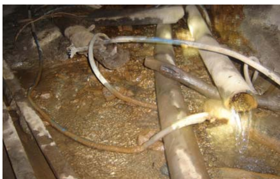
Slika 145. Izliv rudničkih voda iz GTN-1 u "jelovački potkop" - 23.05.2012. (foto B.Miladinović)
