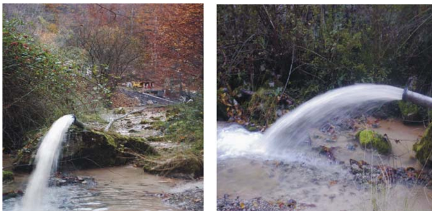
Slika 88. Test crpenja u bunara IEB-1R u klisuri Resavice sa kapacitetom Q= 19,4 l/s (foto B.Miladinović)
