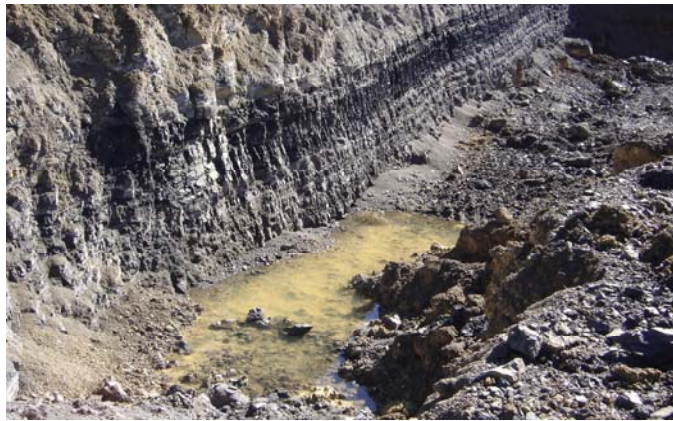
Slika 193. Vodosabirnik u sloju uglja na površinskom kopu kamenog uglja „Progorelica“ (foto B.Miladinović)
