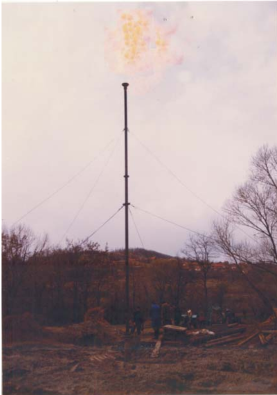
Slika 107. Erupcija metana iz bušotine KM-208 kod Bogdinca u sokobanjskom basenu (foto S.Bačić-Vlahović)
