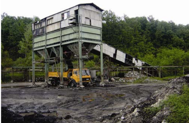
Slika 257. Prihvatni bunker uglja na izlazu iz jame „Bogovina“- istočno polje (foto B.Miladinović)
