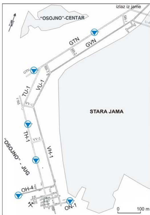
Slika 186. Lokacije pojave rudničkih voda u jami „Lubnica“ (podloga: plan jame Petrović 2009) ▼ - mesto pojave rudničkih voda
