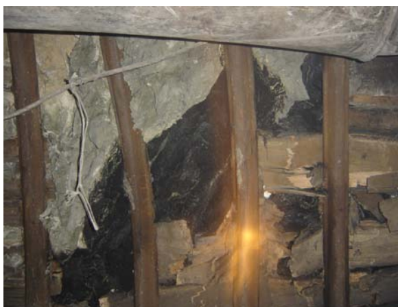
Slika 70. Kontakt laporaca povlate i sloja uglja u ležištu „Bogovina“ – istočno polje (foto B.Miladinović)
