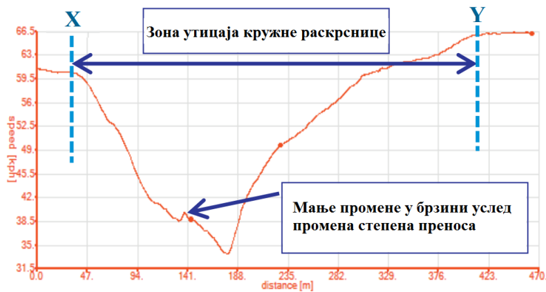
Слика 3.37 Одређивање дужине утицаја кружне раскрснице (Bastos Silva et al., 2014b)
