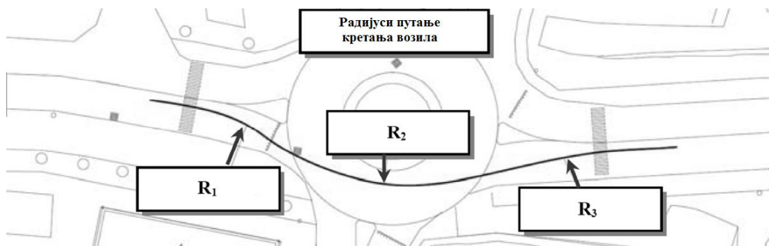
Слика 3.29 Радијуси путање кретања возила кроз кружну раскрсницу на уливу, у кружном току и на изливу (Gallelli et al., 2014)
