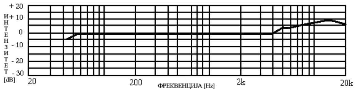
Слика 4.3 Фреквенцијска карактеристика омнидирекционог микрофона.
