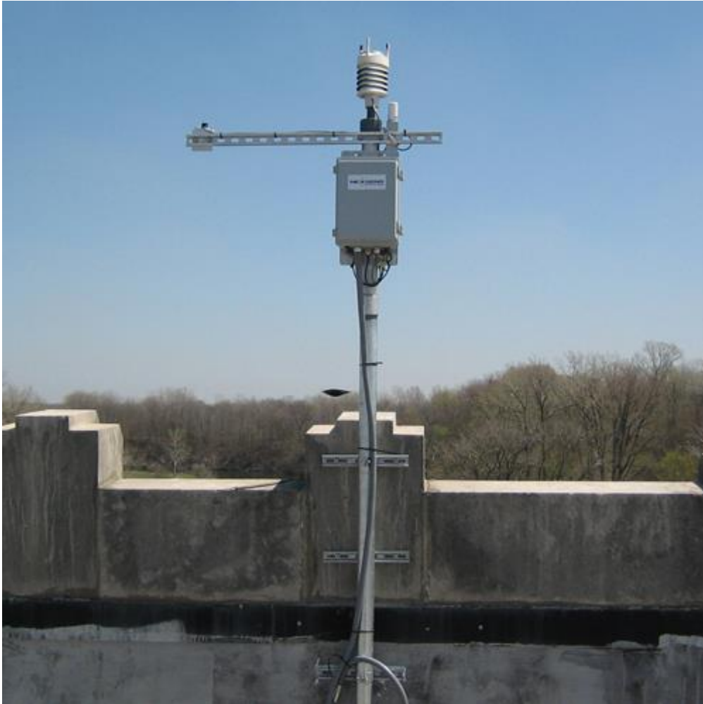
Slika 6.38. Meteo stanica Vaisala WINDCAP WXT520.
