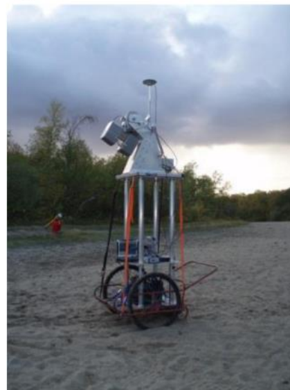
Slika 6.17. MLS sa GPS i IMU jedinicom montiran na: a) čamcu i b) kolicima [167].
