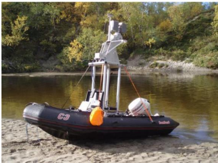
Slika 6.17. MLS sa GPS i IMU jedinicom montiran na: a) čamcu i b) kolicima [167].
